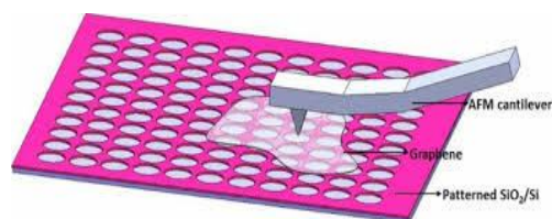
Σχήμα 1.14: Απεικόνιση της διάταξης μέτρησης των μηχανικών ιδιοτήτων του γραφενίου με τη μέθοδο της νανοδιείσδυσης σε μικροσκόπιο ατομικής δύναμης.
