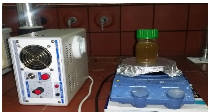
Εικόνα 4.6: Φωτογραφία της διάταξης κατά τη φωτοκαλυτική αποδόμηση της methylorange (πριν την ακτινοβολία με ορατό φως)
