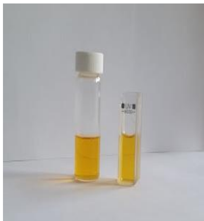
Εικόνα 4.7: Φωτογραφία των δειγμάτων MO σε χρόνο 0 λεπτών, χωρίς φωτοκαταλύτη (αριστερά) και σε χρόνο 60 λεπτών, χωρίς φίλτρο με φωτοκαταλύτη (δεξιά)
