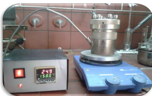
Εικόνα 4.3: Φωτογραφία του αυτόκλειστου με διάταξη θερμοστοιχείου για έλεγχο της θερμοκρασίας
