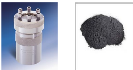
Εικόνα 4.5: Φωτογραφία του αυτόκλειστου (αριστερά) και του τελικού προϊόντος GO/ZnIn_2S_4 (δεξιά)
