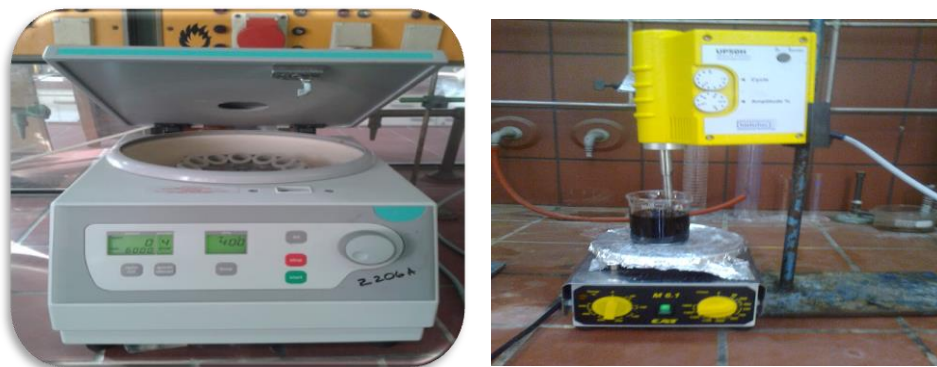
Εικόνα 4.4: Φωτογραφία της φυγόκεντρου (αριστερά) και της διάταξης επιβολής υπερήχων με ταυτόχρονη ανάδευση (δεξιά)
