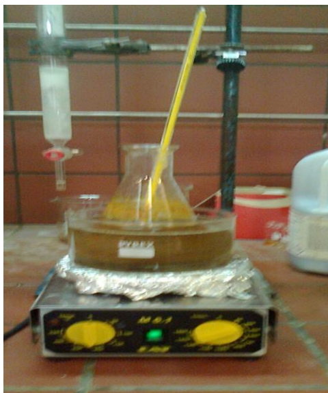
Εικόνα 4.1: Φωτογραφία του σταδίου ανάδευσης και θέρμανσης του μίγματος, κατόπιν προσθήκης υδατικού διαλύματος 5% H_2SO_4
