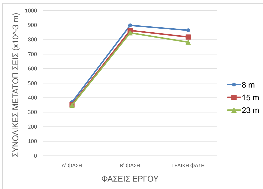
Διάγραμμα 1 : Συγκεντρωτική απεικόνιση των συνολικών μετατοπίσεων μετά το τέλος κάθε φάσης του έργου, για μήκη χαλικοπασσάλων 8, 15, 23 m και με ενεργοποιημένους όλους τους χαλικοπασσάλους.
