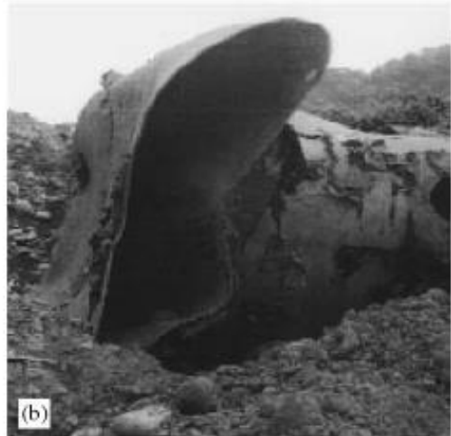
Σχήμα 1.5.9. Αστοχία μεγάλων αγωγών σε ενεργά ρήγματα. (a) 1999 Kocaeli, Τουρκία, (b) 1999 Chi-Chi, Taiwan. (Takada et al.2001)
