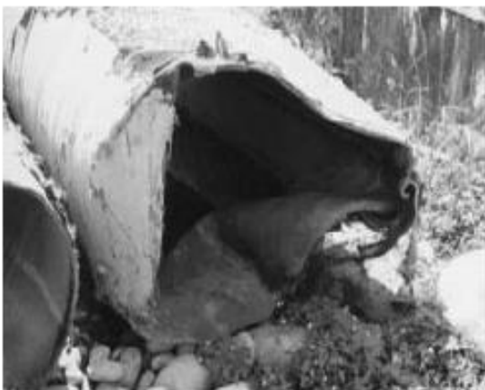
Σχήμα 1.5.8 Μεγάλες παραμορφώσεις χαλύβδινου αγωγού λόγω μεγάλων μετακινήσεων εδάφους (1999 Chi-Chi earthquake, Takada et al.2001).
