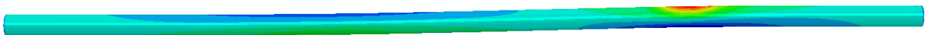
Σχήμα 5.1.5 (α) Η θέση του αγωγού για κατακόρυφη μετατόπιση ρήγματος h για κανονικό ρήγμα γωνίας \beta=30^\circ . Αξονικές παραμορφώσεις του αγωγού για την (β) κάτω ίνα και (γ) άνω ίνα (δ) οι αξονικές παραμορφώσεις του αγωγού στο πλήρως αριθμητικά συζευγμένο προσομοίωμα.
