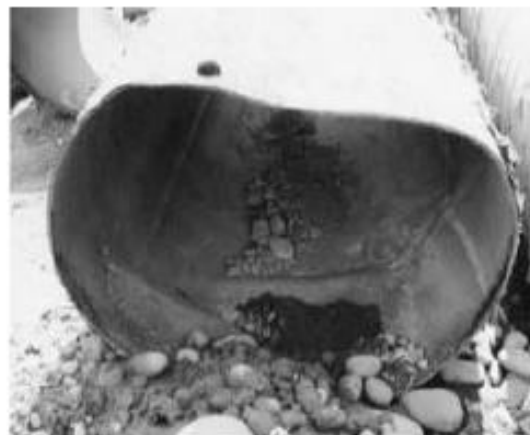
Σχήμα 1.5.8 Μεγάλες παραμορφώσεις χαλύβδινου αγωγού λόγω μεγάλων μετακινήσεων εδάφους (1999 Chi-Chi earthquake, Takada et al.2001).
