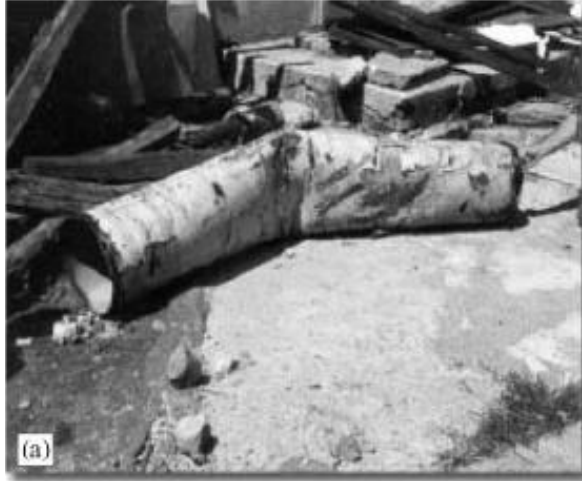
Σχήμα 1.5.9. Αστοχία μεγάλων αγωγών σε ενεργά ρήγματα. (a) 1999 Kocaeli, Τουρκία, (b) 1999 Chi-Chi, Taiwan. (Takada et al.2001)
