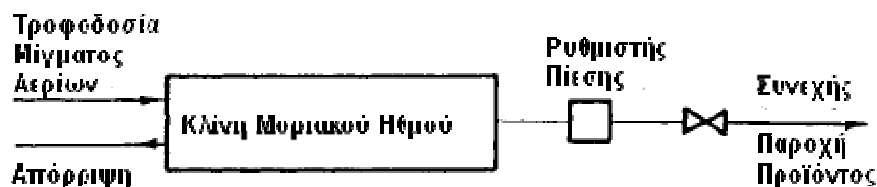
Εικόνα 4.11: Ο κύκλος δύο σταδίων μονής κλίνης: Τροφοδοσία υπό υψηλή πίεση και απόρριψη υπό χαμηλή πίεση [57] .
