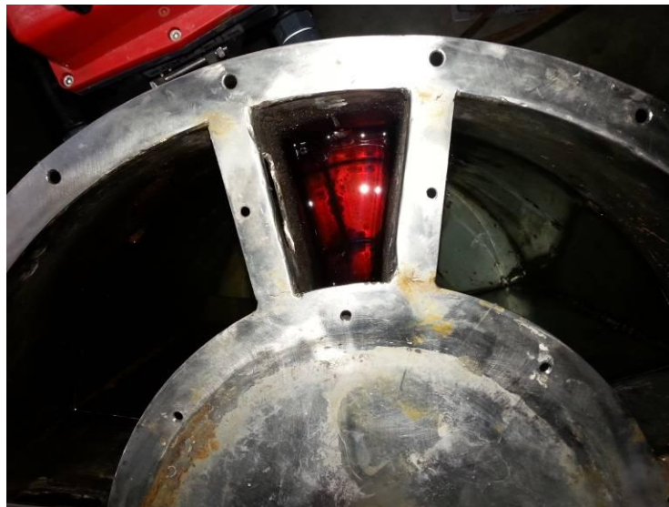
Εικόνα 2: Κάτοψη πιλοτικού PABR ενεργού όγκου 80 λίτρων.
