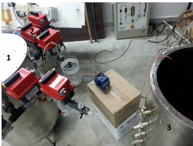
Εικόνα 4: Πειραματική διάταξη πιλοτικού PABR όπου φαίνονται: 1. ο αντιδραστήρας, 2. οι συστοιχίες των ηλεκτροβανών, 3. το δοχείο τροφοδοσίας, 4. η δοσομετρική αντλία, 5. το δοχείο συλλογής της εκροής, 6. ο σωλήνας τροφοδοσίας και 7. η εκροή του αντιδραστήρα.
