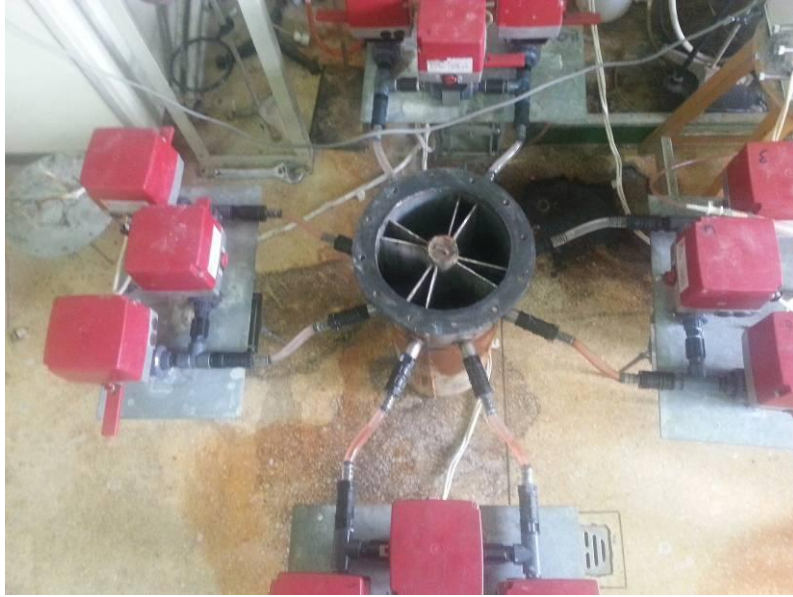
Εικόνα 1: Κάτοψη εργαστηριακού PABR ενεργού όγκου 15 λίτρων.
