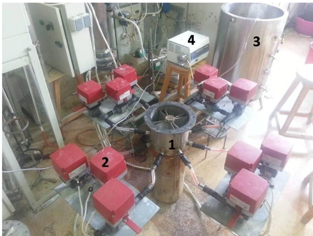
Εικόνα 3: Πειραματική διάταξη εργαστηριακού PABR όπου φαίνονται: 1. ο αντιδραστήρας, 2. οι συστοιχίες των ηλεκτροβανών, 3. το δοχείο τροφοδοσίας και 4. η περισταλτική αντλία.
