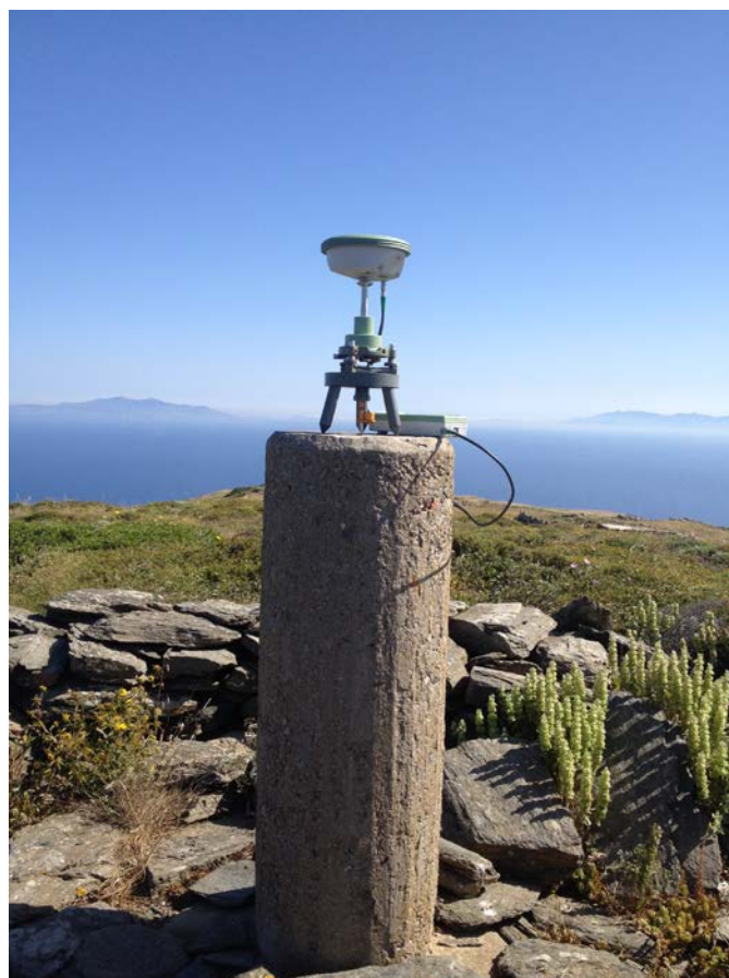
Εικόνα 12: Μέτρηση με το σύστημα GPS στο τριγωνομετρικό βάθρο της ΓΥΣ «Καυκάρες»
