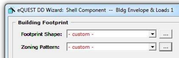
Σχήμα 5.4:Ορίζοντας στην επιλογή «Footprint Shape : Custom», υπάρχει η δυνατότητα να οριστεί η κάτοψη που επιθυμεί ο χρήστης.
