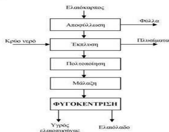
Διάγραμμα 2. Σχηματικά απόδοση των σταδίων επεξεργασίας σε ελαιοτριβείο φυγοκεντρικού τύπου δύο φάσεων.
