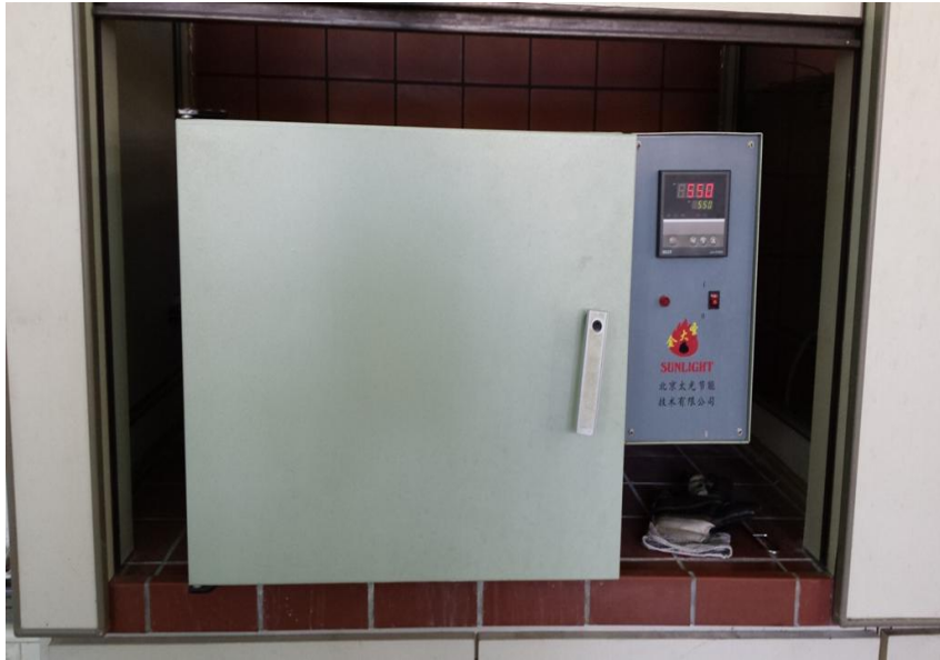
Εικόνα 12. Φούρνος θερμοκρασίας 550 οC για την αποτέφρωση του compost
