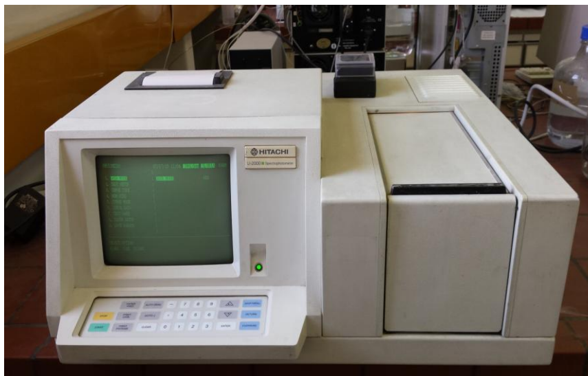
Εικόνα 13. Σκεπτοφωτόμετρο Hitachi 2000 για την μέτρηση τόσο της απορρόφησης όσο και της συγκέντρωσης σε μήκος κύματος 415nm
