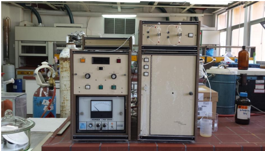
Εικόνα 14. Συσκευή TOC-analyser για την μέτρηση των χουμικών και φουλβικών οξέων
