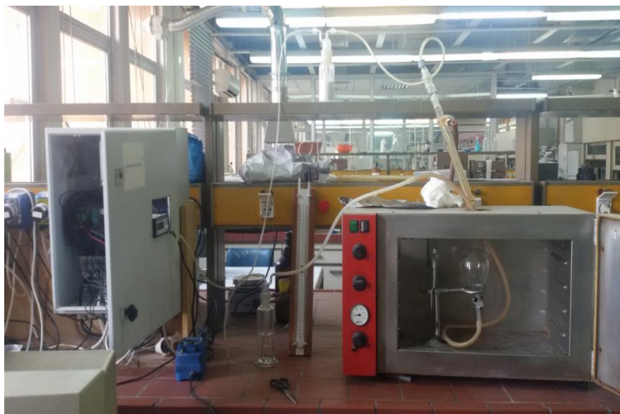
Εικόνα 17. Διάταξη αναπνευσιομέτρου για την μέτρηση της κατανάλωσης οξυγόνου
