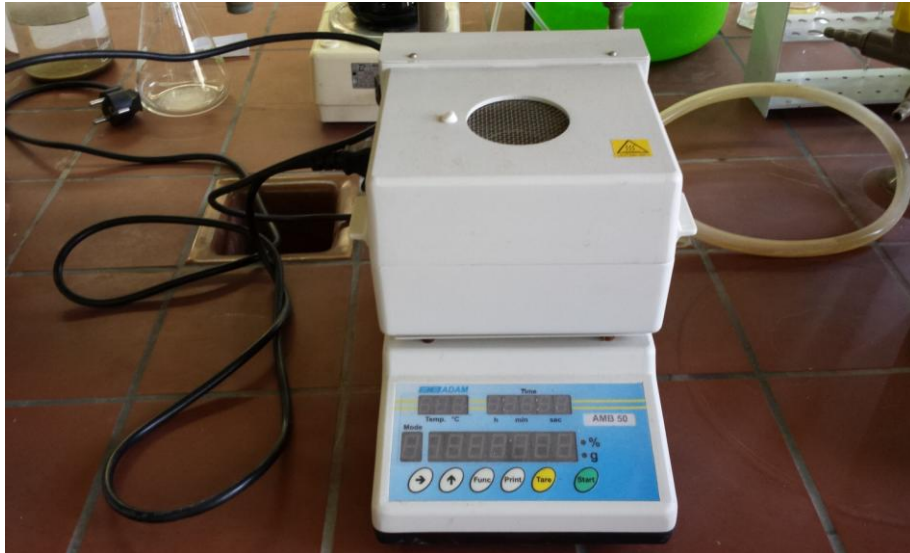
Εικόνα 11. Συσκευή υγρασιόμετρου για την μέτρηση της τιμής της υγρασίας του κόμποστ σε υγρή βάση M_{wb} .
