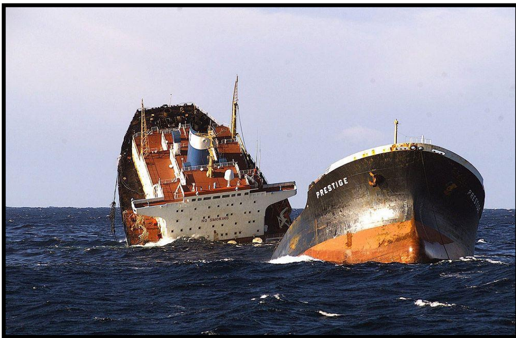
Εικόνα 1.3-9 : Το Prestige καταρρέει κατασκευαστικά και παραδίνεται στη θάλασσα. (πηγή:www.cresco.com)
