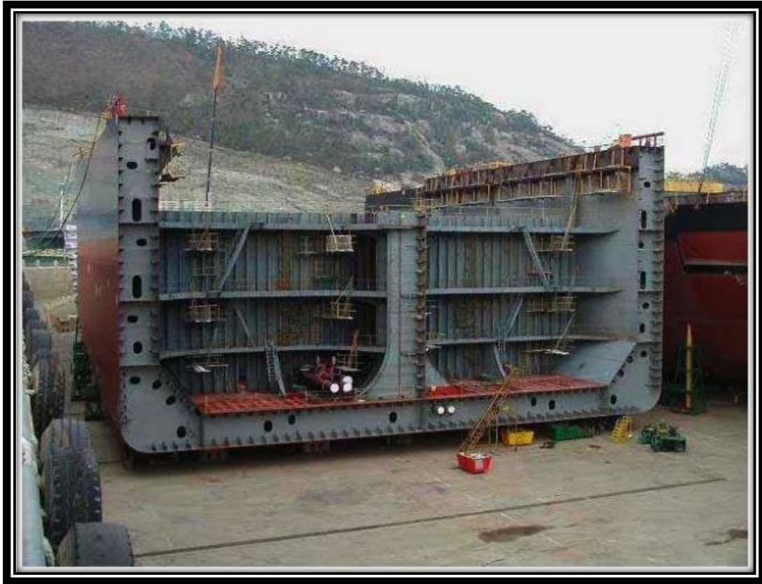
Εικόνα 1.2-4 : Τυπική διάταξη L ενός tanker με double hull (πηγή: www.pwsrcc.org )
