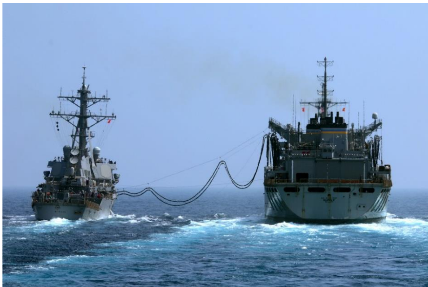
Εικόνα 1.1-2 : Το USNS Supply ATLANTIC OCEAN ανεφοδιάζει το πολεμικό καταστροφικό USS McFaul εν κινήσει 2011 (πηγή: U.S. Navy photo)
