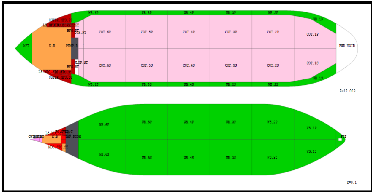
Σχήμα 5.1-1 : Διάταξη δεξαμενών πλοίου "SIR NIKOLAS"
