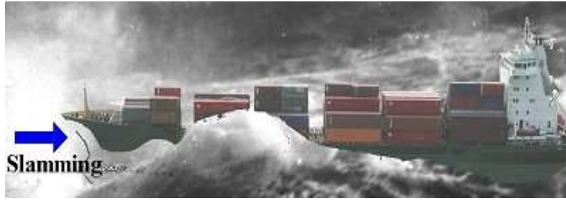
Εικόνα 1.2. Slamming στην πρόρη αλλά και στο μέσο τμήμα container-ship λόγω μετωπικών κυματισμών.
