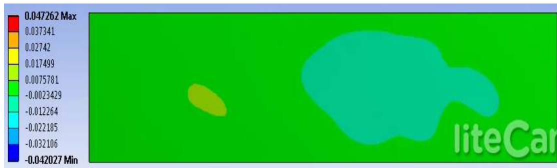
Εικόνα 7.12. Καμπτικές ταλαντώσεις της πλάκας w(y, z) (m) από τη μη-γραμμική δυναμική επίλυση ΠΣ μετά τη 15 η περίοδο, για 4-κομβικά στοιχεία κελύφους 0.04 \times 0.04 .
