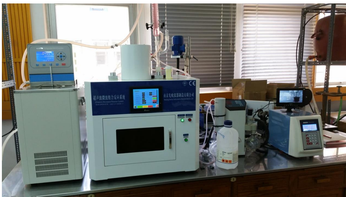
Εικόνα 4: Εργαστηριακή συσκευή εκχύλισης με μικροκύματα και υπερηχητική ακτινοβολία
