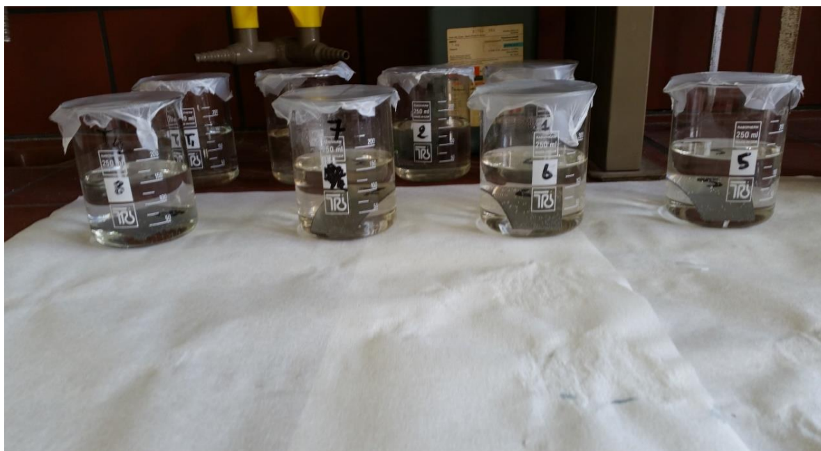
Εικόνα 10: Εκτέλεση του πειράματος απώλειας βάρους των δοκιμίων χάλυβα 304 σε διαβρωτικό διάλυμα HCl 1M.
