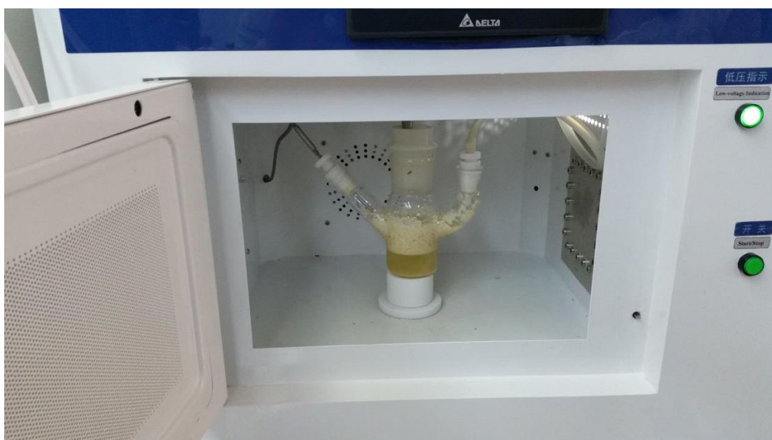
Εικόνα 5: Εκχύλιση σκόνης από τις φλούδες πορτοκαλιού με νερό σε συσκευή εκχύλισης με μικροκύματα
