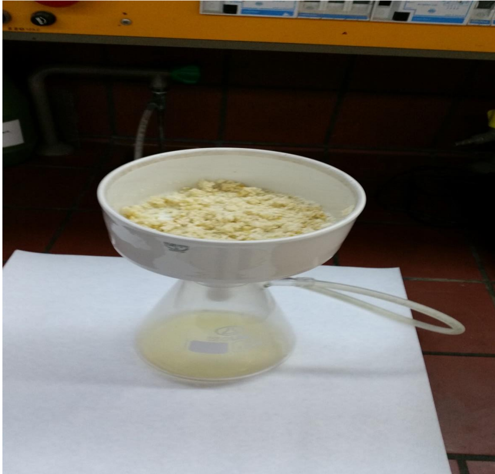
Εικόνα 6: Διήθηση με κενό υδατικού εκχυλίσματος πορτοκαλιού (προερχόμενο από εκχύλιση με νερό σε μικροκύματα)
