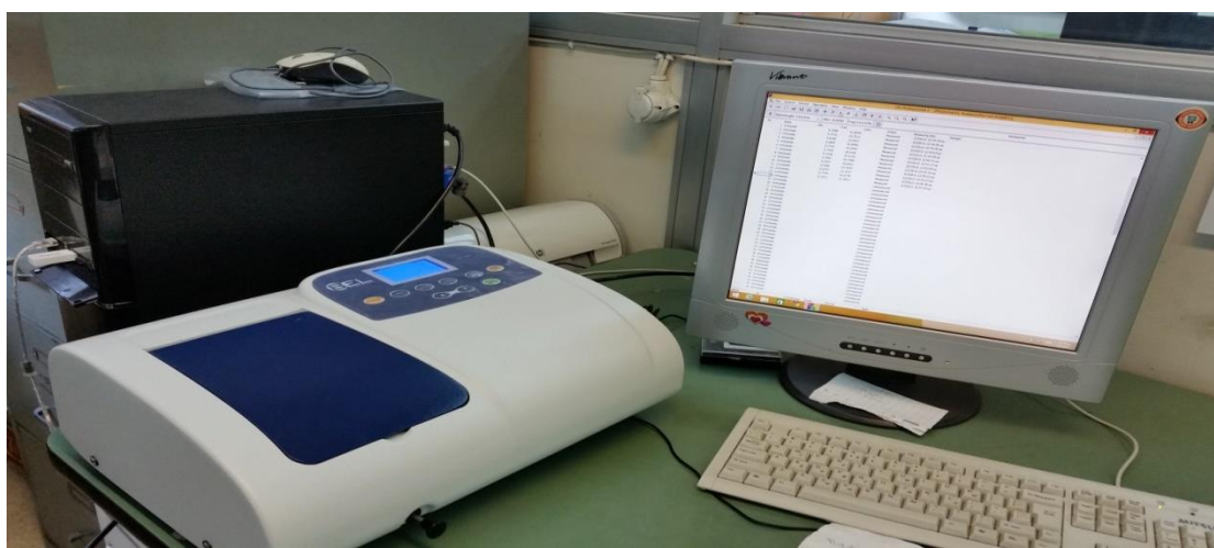
Εικόνα 12: Καταμέτρηση της απορρόφησης σε συσκευή UV-Vis
