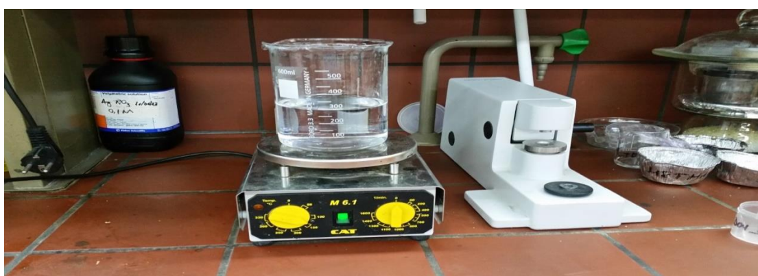
Εικόνα 3: Βρασμός αποσταγμένου νερού για τη μείωση διαλυτότητας των αερίων σε αυτό.
