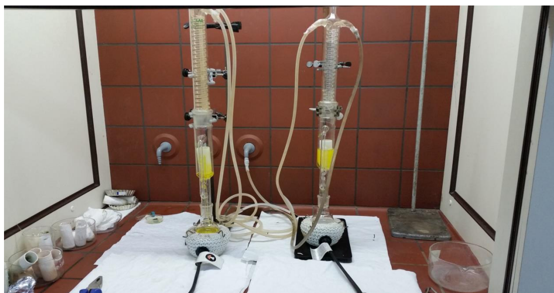
Εικόνα 1: Εκχύλιση αλεσμένων φλούδων πορτοκαλιού με διαλύτη Εξάνιο.
