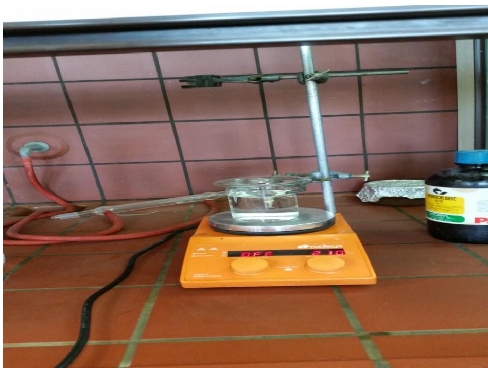
Εικόνα 9 : Εκχύλιση με ανάδευση των αναστολέων στο διάλυμα HCl 1M.
