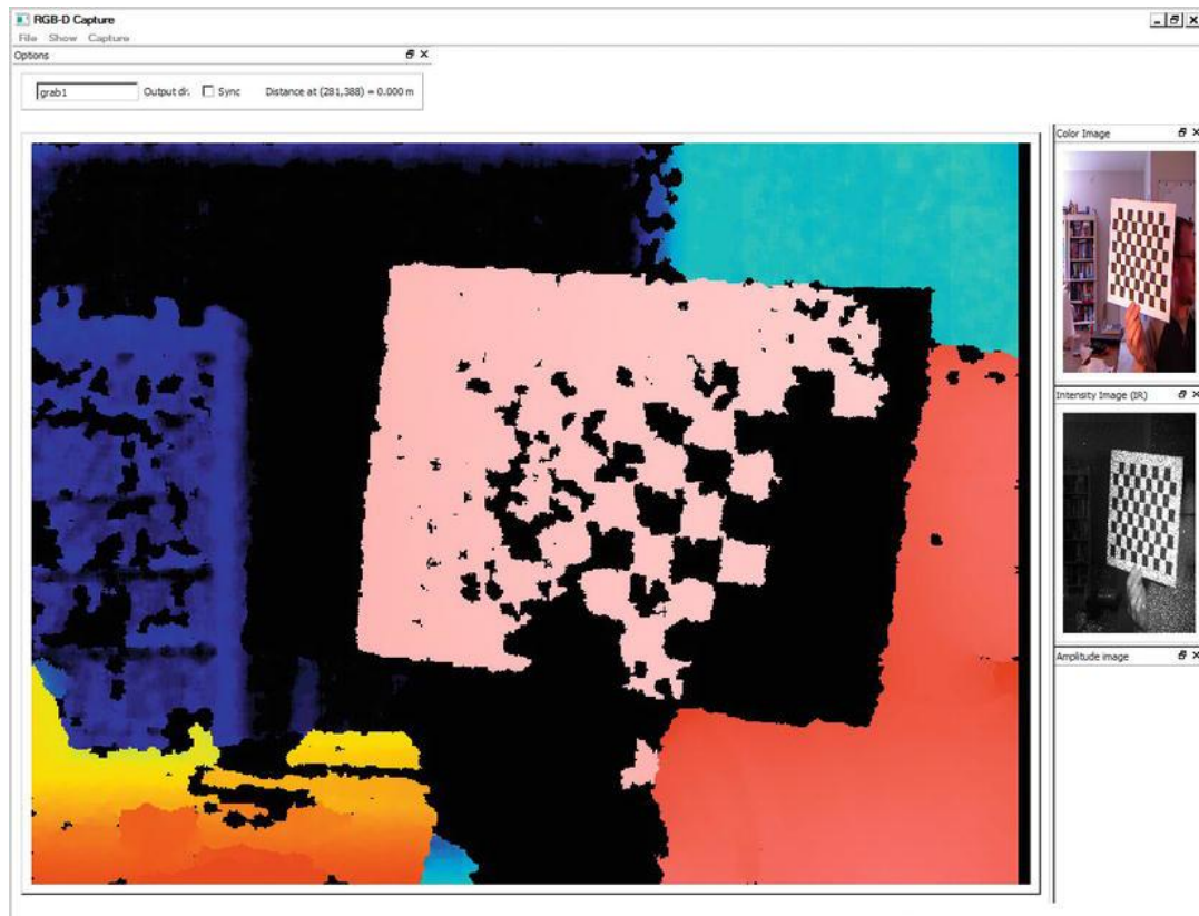
Εικόνα 5–2: Ένα παράδειγμα θέσης λήψης εικόνας κατά τη βαθμονόμηση Πηγή: J. Kramer, N.Burrus, D. Herrera C., F. Ehtler, M. Parker, “Hacking the Kinect”, 2012
