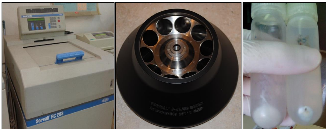
Σχήμα 4.11. Διάταξη φυγοκέντρωσης Sorvall RC 28S DuPont (αριστερά), κεφαλή φυγοκέντρωσης Sorvall F-28/50 (κέντρο) και σωληνάρια τύπου Oak Ridge των 50 ml με σχηματισμένα pellet σωματιδίων στα τοιχώματά τους
