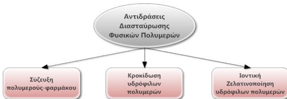
Σχήμα 3.5. Κύριες τεχνικές παρασκευής πολυμερικών νανο- και μικρο- σωματιδίων μέσω αντιδράσεων διασταύρωσης φυσικών πολυμερών
