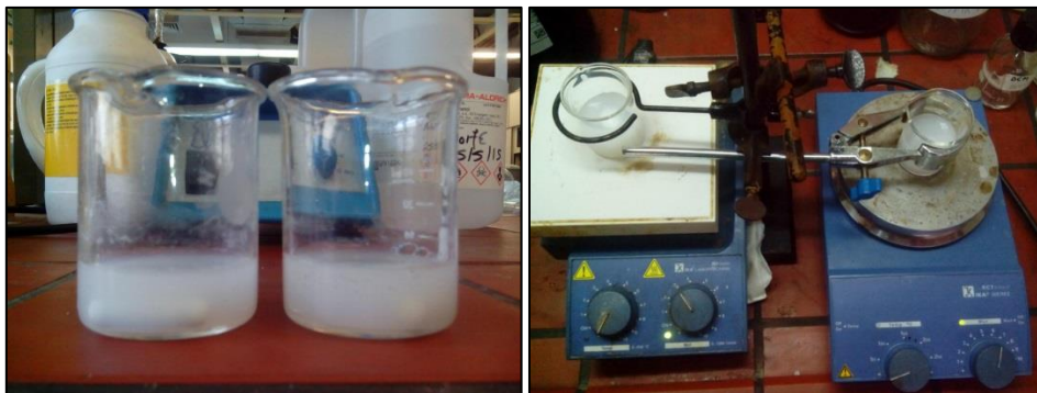
Σχήμα 4.10. Μακροσκοπική εικόνα O/W γαλακτωμάτων μετά τη διαδικασία γαλακτωματοποίησης και διάταξη απομάκρυνσης του οργανικού διαλύτη υπό μαγνητική ανάδευση
