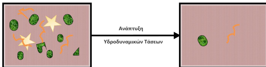
Σχήμα 2.8. Αναπαράσταση αυτοκαθαρισμού επικάλυψης τύπου FRC με ανάπτυξη υδροδυναμικών τάσεων
