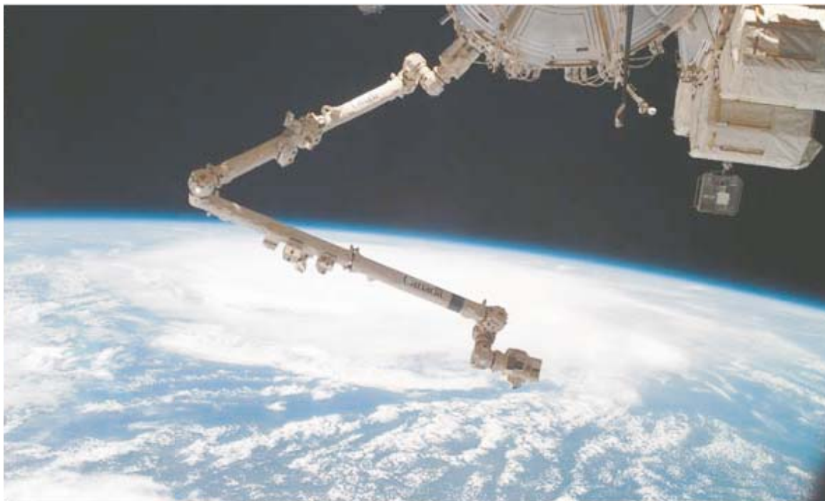
Σχήμα 1.2 Ο Διαστημικός ρομποτικός βραχίονας Canadarm 2 παρουσιάζει ευκαμψίες στους συνδέσμους του, λόγω του μεγάλου μήκους του.
