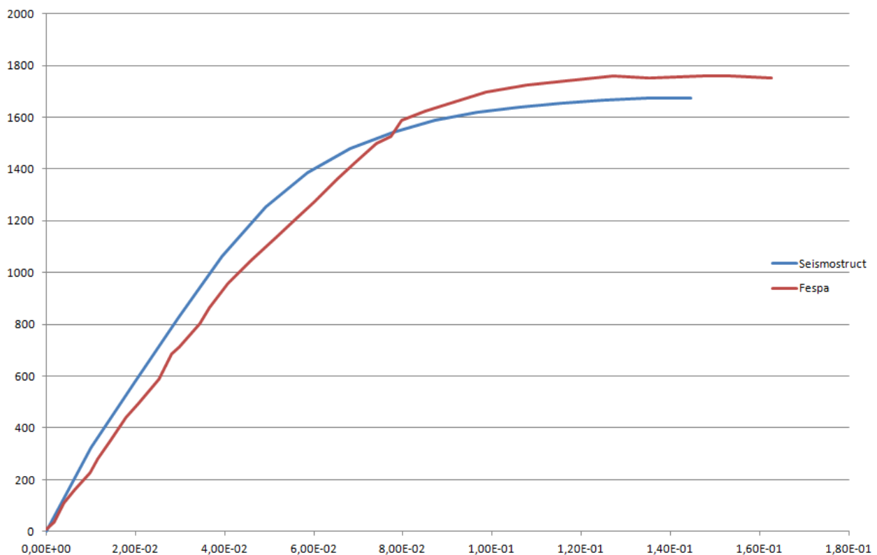
Σχήμα 6.1. Διάγραμματα ικανότητας (P-δ) λογισμικών Fespa και Seismostruct για φόρτιση κατά X
