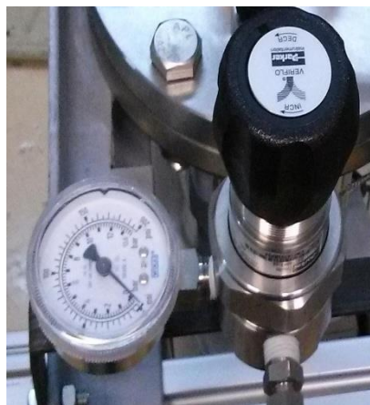
Σχήμα 3- 14: Αριστερά-Σχέδιο ρυθμιστή πίσω πίεσης, Δεξιά-Σχέδιο ρυθμιστής πίσω πίεσης
