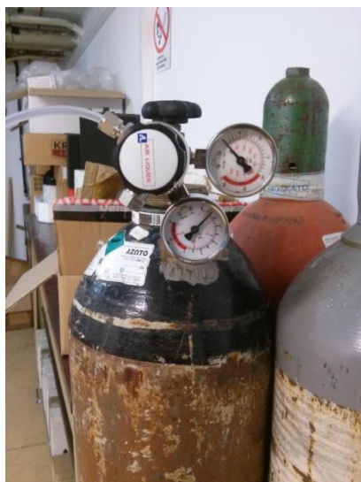
Σχήμα 3- 13: Αριστερά-Μπουκάλες αερίων με μειωτήρα πίεσης, Δεξιά-Σχέδιο μπουκάλας με μειωτήρα πίεσης.
