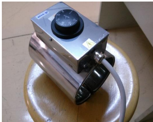
Σχήμα 3- 11: Εφαρμογή θέρμανσης: Μηχανικός θερμοστάτης.
