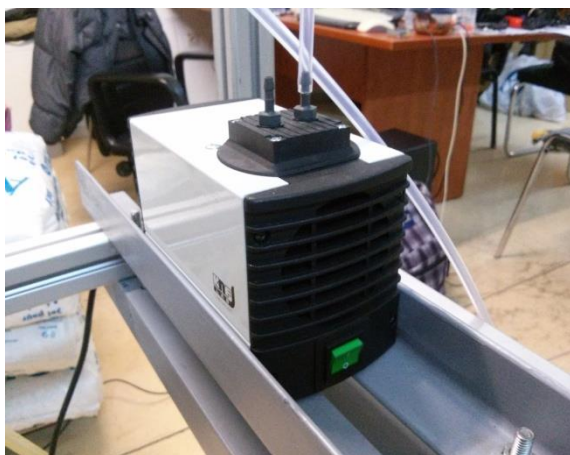
Σχήμα 3- 10: Αριστερά: Αντλία κενού, Δεξιά: Σχέδιο αντλίας κενού.
