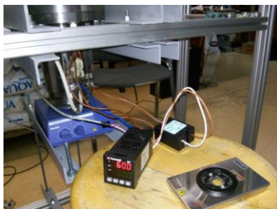
Σχήμα 3- 12: Εφαρμογή θέρμανσης-Λογικός ελεγκτής θερμοκρασίας με PID.
