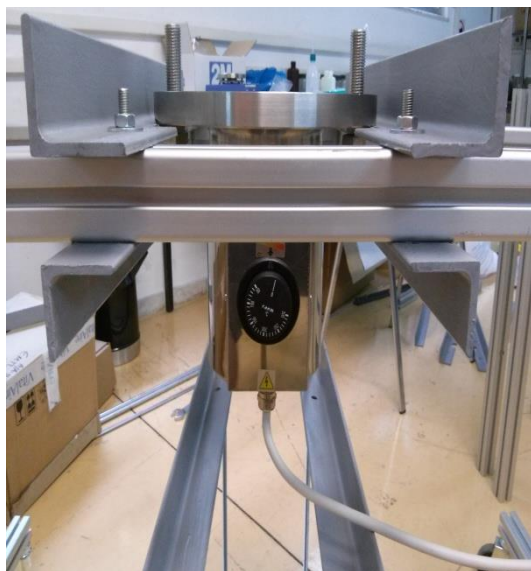
Σχήμα 3- 9: Αριστερά: Στήριξη δοχείου ισορροπίας, Δεξιά: Σχέδιο συνολικής στήριξης δοχείου σε λαμαρίνες και σε αναδευτήρα.
