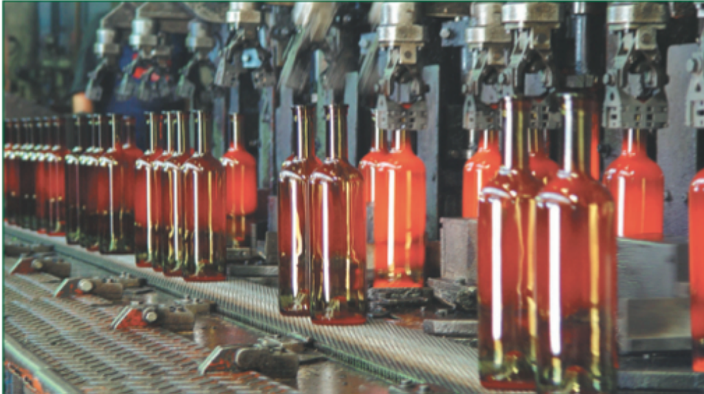
Εικόνα 2.1: Έξοδος διάπυρων φιαλών από τα καλούπια [12].
