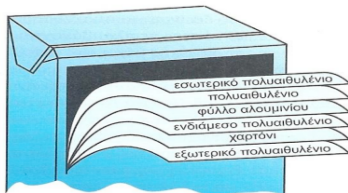
Σχήμα 2.12: Τυπική σύσταση του laminate για τα χάρτινα κουτιά ασηπτικής συσκευασίας [16].
