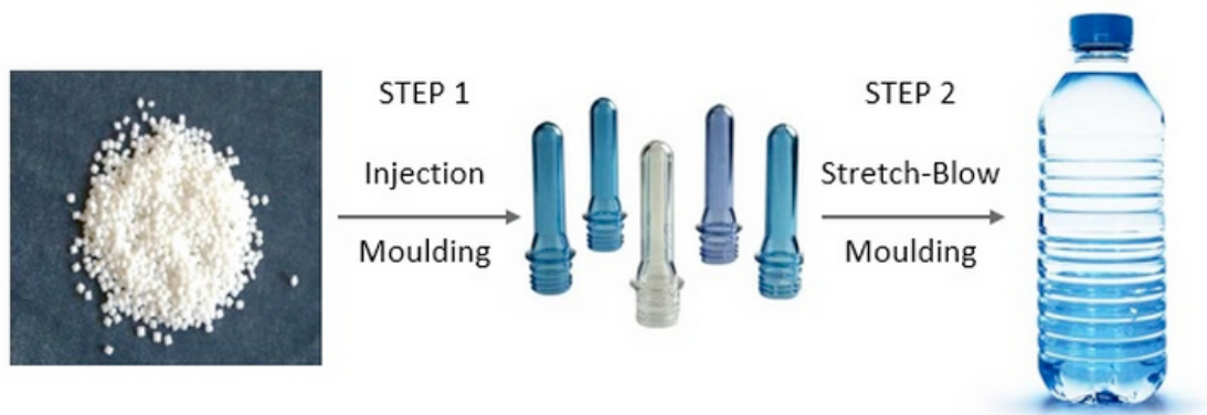
Εικόνα 2.3: Στάδια παραγωγής πλαστικού μπουκαλιού [13].
