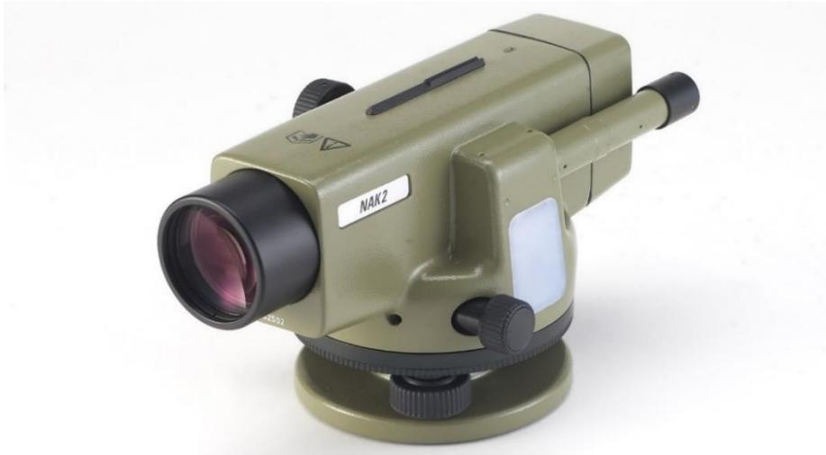
*Εικόνα 1.2: Οπτικομηχανικός χωροβάτης Leica NAK2 (Πηγή:
