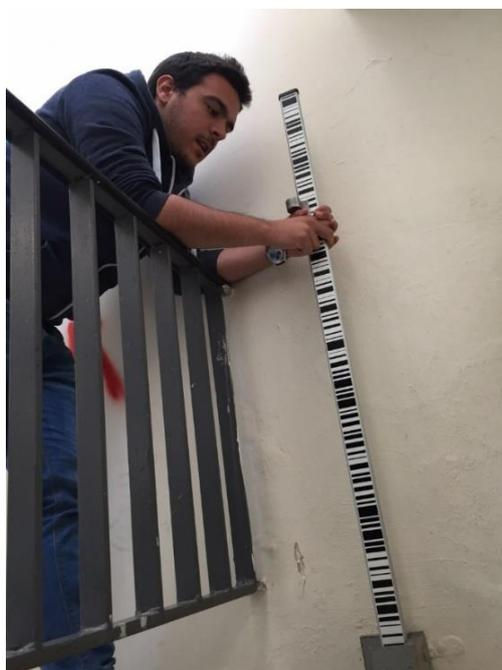
*Εικόνα 3.8: Μέτρηση δεύτερου τμήματος σταδίας Leica Sprinter 150M (2102227, 741882) στη στάθμη 10*
