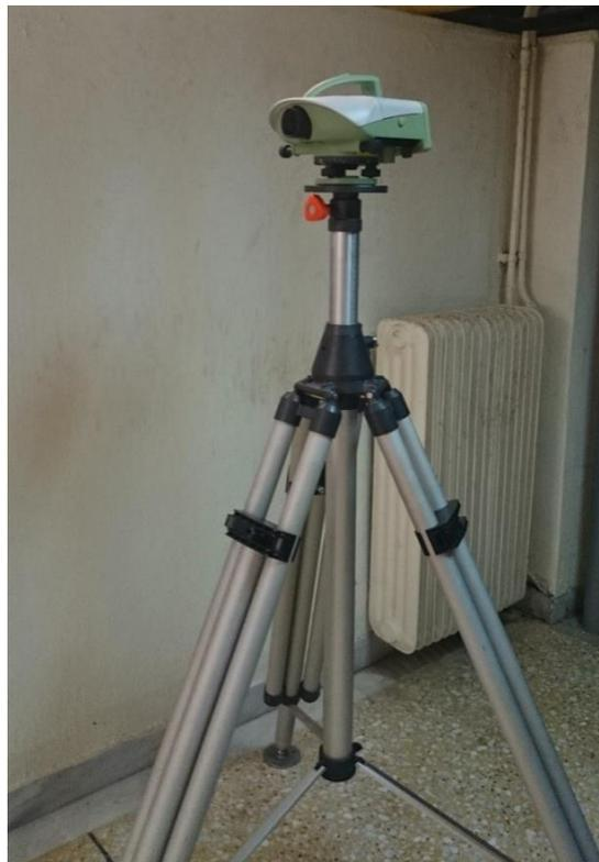
*Εικόνα 2.4: Μετρήσεις βαθμονόμησης με τον Leica DNA03*
