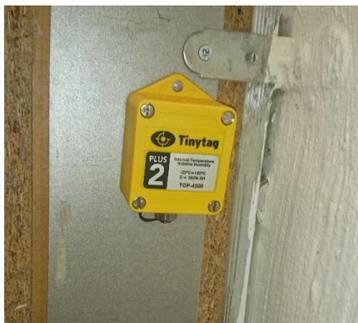
*Εικόνα 2.3: Το Tinytag PLUS 2 TGP-4500 τοποθετημένο στην πίσω πλευρά της βάσης ελέγχου*
