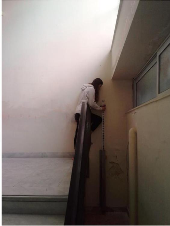
*Εικόνα 3.3: Μέτρηση δεύτερου τμήματος σταδίας
