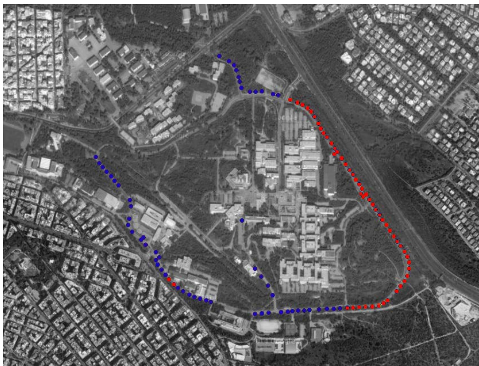
Σχήμα 42 – Φωτιστικά της 2 ης ομάδας φωτιστικών με λαμπτήρες ατμών νατρίου χαμηλής πίεσης (κόκκινο χρώμα)
