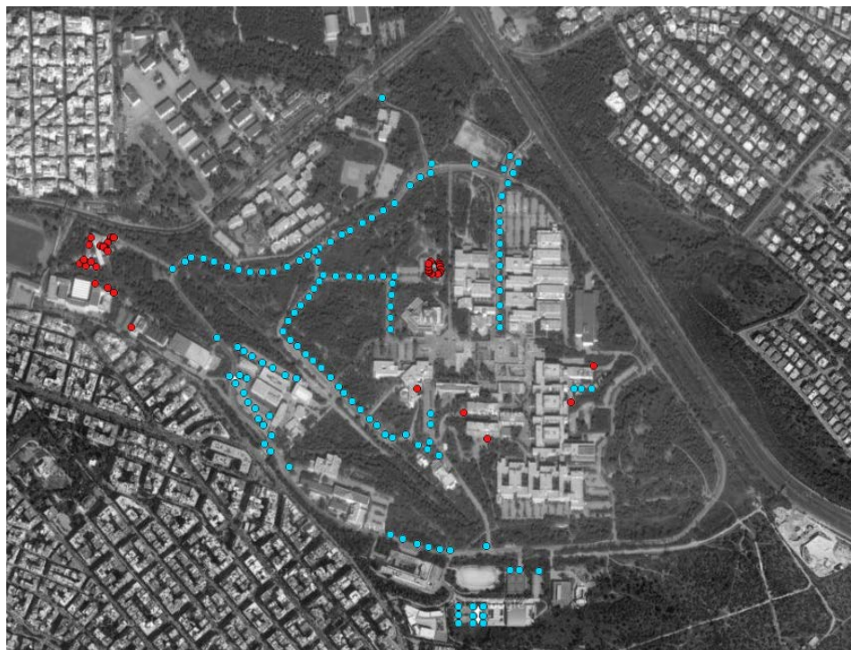
Σχήμα 35 – Φωτιστικά με λαμπτήρες ατμών νατρίου υψηλής πίεσης ως προβολείς σε κτίρια (κόκκινο χρώμα)
