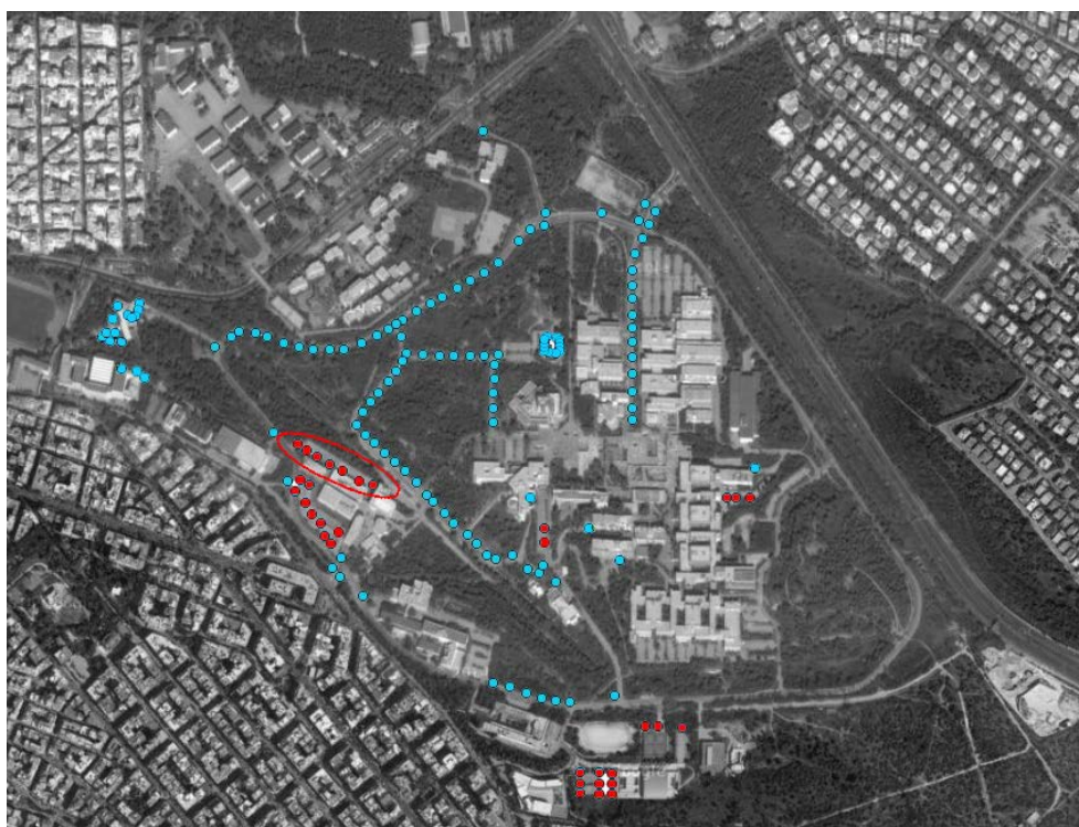
Σχήμα 32 – Φωτιστικά σε χώρους στάθμευσης αυτοκινήτων με λαμπτήρες ατμών νατρίου υψηλής πίεσης (κόκκινο χρώμα)
