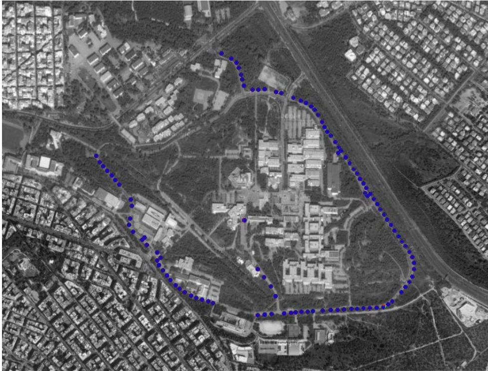
Σχήμα 15 – Φωτιστικά με λαμπτήρες ατμών νατρίου χαμηλής πίεσης στο Ε.Μ.Π.
