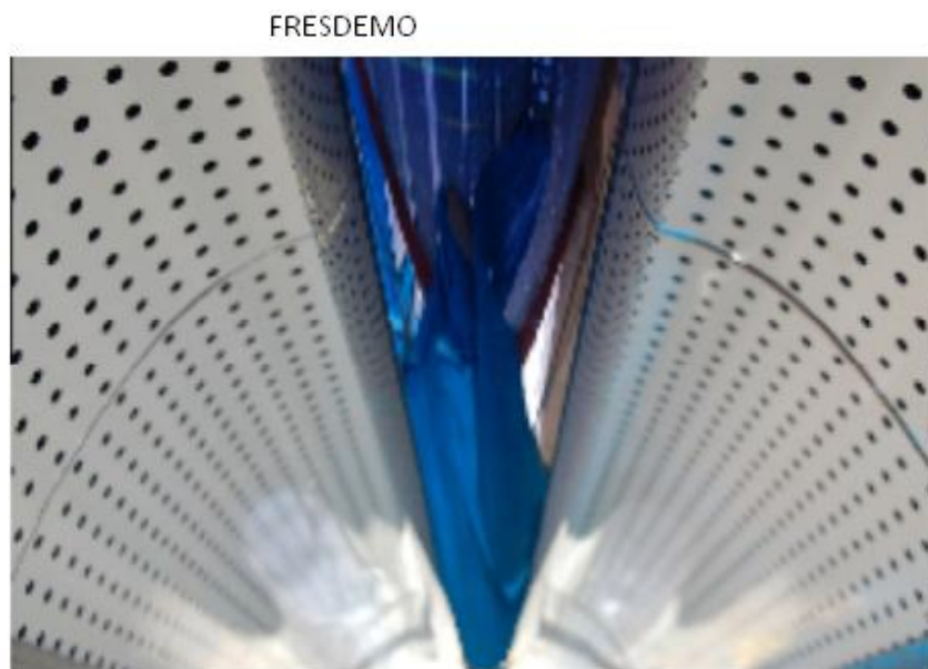
Εικόνα 4.10: Διάταξη δέκτη που χρησιμοποιείται για το έργο FRESDEMO, ο δευτερεύον συλλέκτης είναι εφοδιασμένος με φωτομετρικές μετρήσεις
