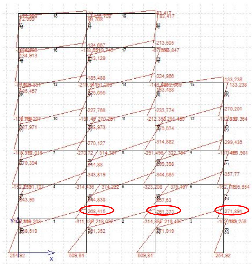
30 - Διάγραμμα ροπών [M] για το πλαίσιο με εσοχή, ομοιόμορφες διατομές & επαναληπτική ανάλυση
