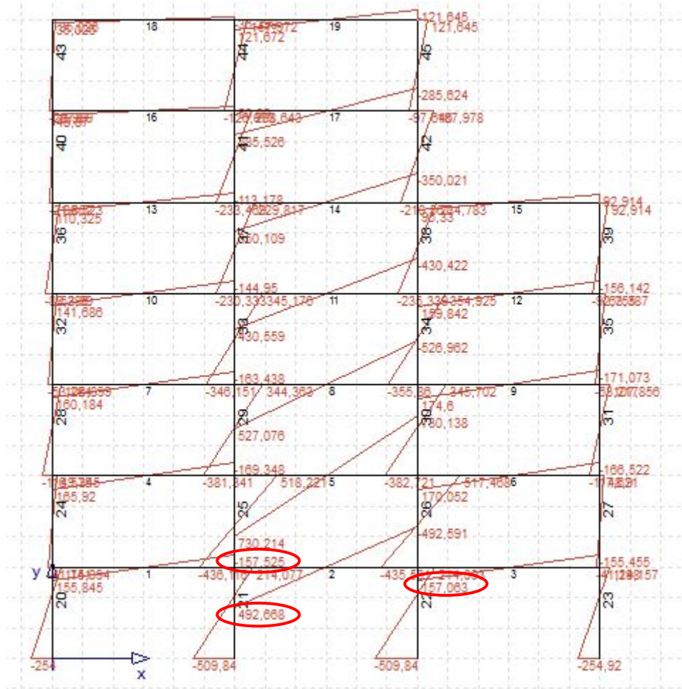
31 - Διάγραμμα ροπών [M] για το κανονικό πλαίσιο με κλιμακωμένες διατομές & επαναληπτική ανάλυση
