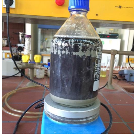
Σχήμα 4.6.3.2. Φωτογραφία του βιοαντιδραστήρα διαλείποντος έργου περιοδικής λειτουργίας στερεής- υγρής φάσης κατά τη φάση της καθίζησης.
