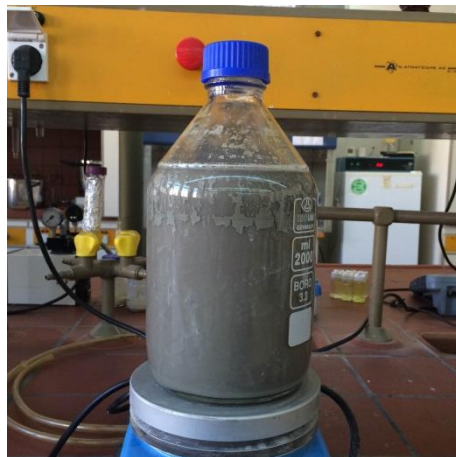
Σχήμα 4.6.3.1. Φωτογραφία του βιοαντιδραστήρα διαλείποντος έργου περιοδικής λειτουργίας στερεής- υγρής φάσης κατά τη φάση της αντίδρασης.
