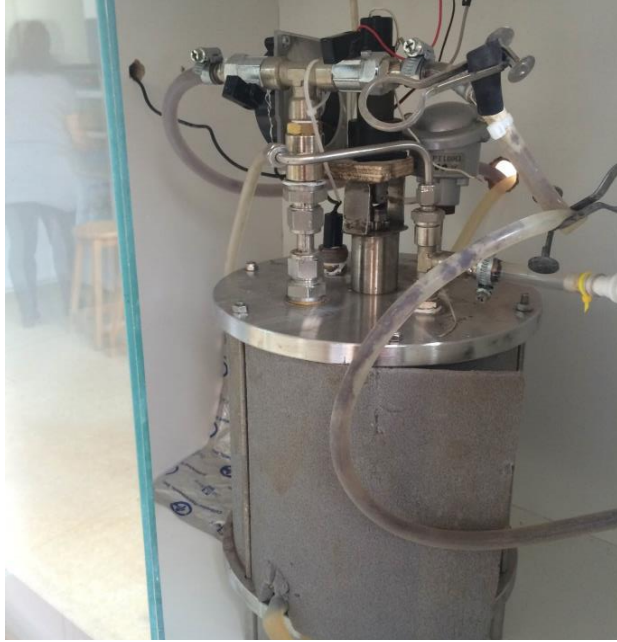
Σχήμα 4.6.4.1: Πρόσψη του εργαστηριακού διφασικού αναερόβιου αντιδραστήρα υγρής- στερεής φάσης.
