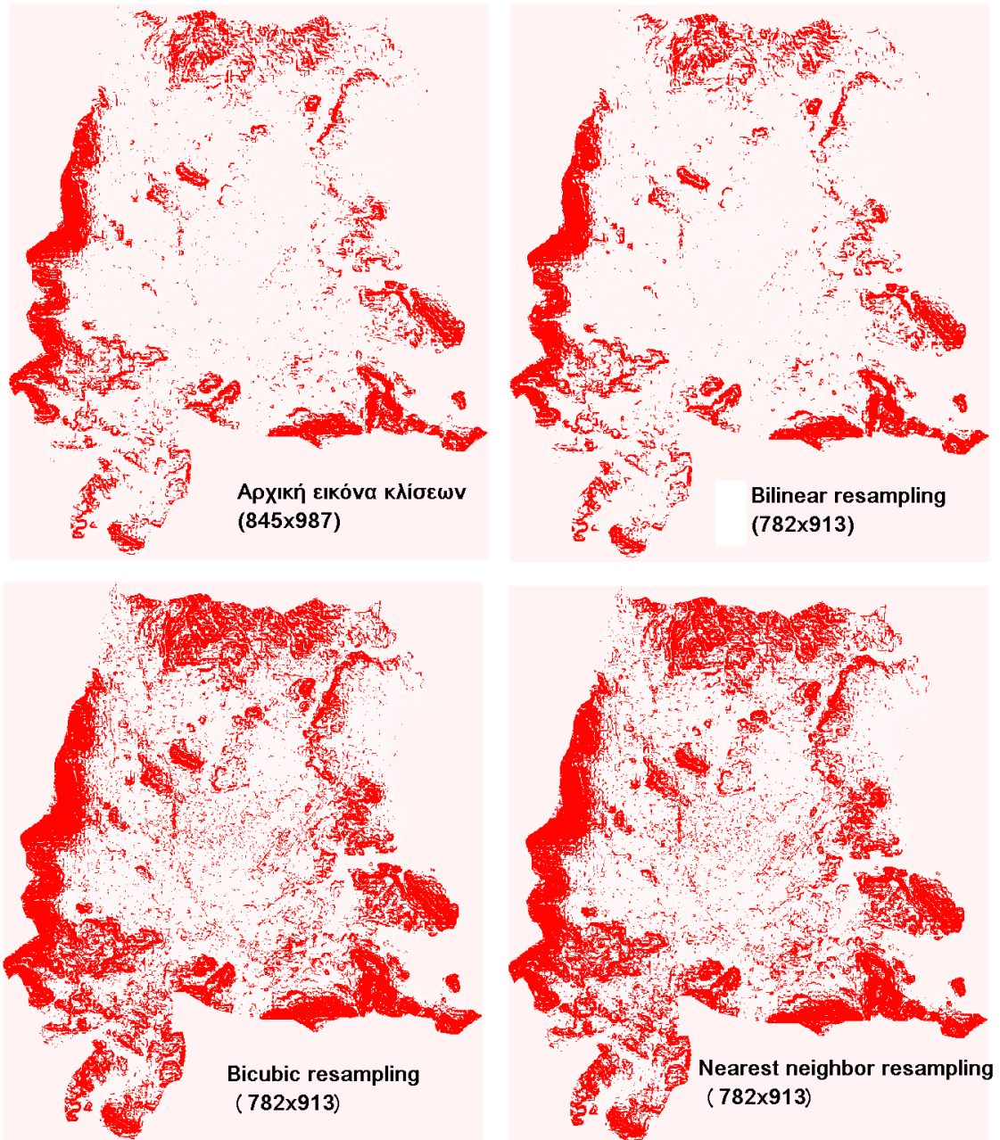
Εικόνα 4-3: Σύγκριση των μεθόδων resampling, όπου φαίνονται με κόκκινο χρώμα τα pixels με τιμή κλίσης πάνω από 21%
