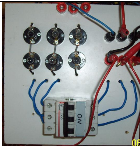
Σχήμα 6.3 Αυτοσχέδια διάταξη ελέγχου των συνθηκών παραλληλισμού
