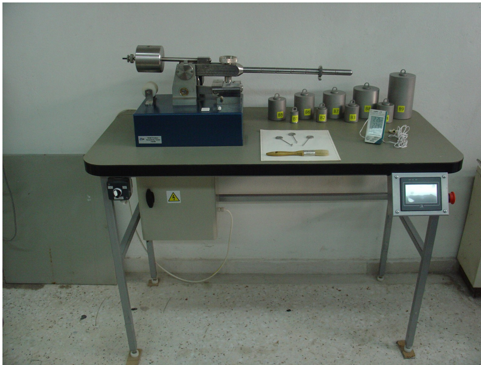
Εικόνα 13: Εξοπλισμός και συσκευή δοκιμής BAM, Εργαστήριο Εξόρυξης Πετρωμάτων ΕΜΠ
