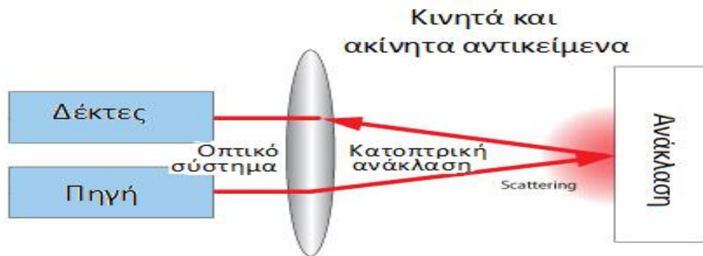
Εικόνα 5.9: Αρχή λειτουργίας αισθητήρα ανάκλασης
