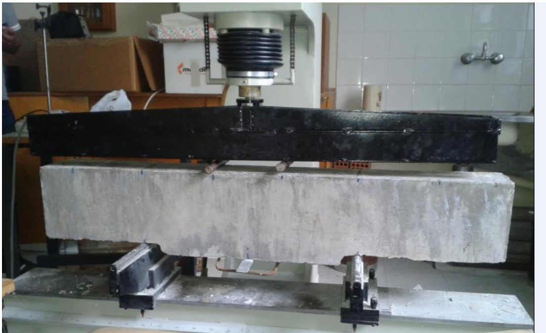
Εικ. 55 Πειραματική διάταξη για θετικές ροπές
