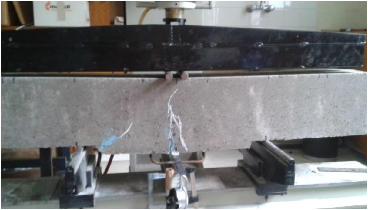
Εικ. 92 Δοκός με ελλiptή αγκύρωση στη κατάσταση αστοχίας
