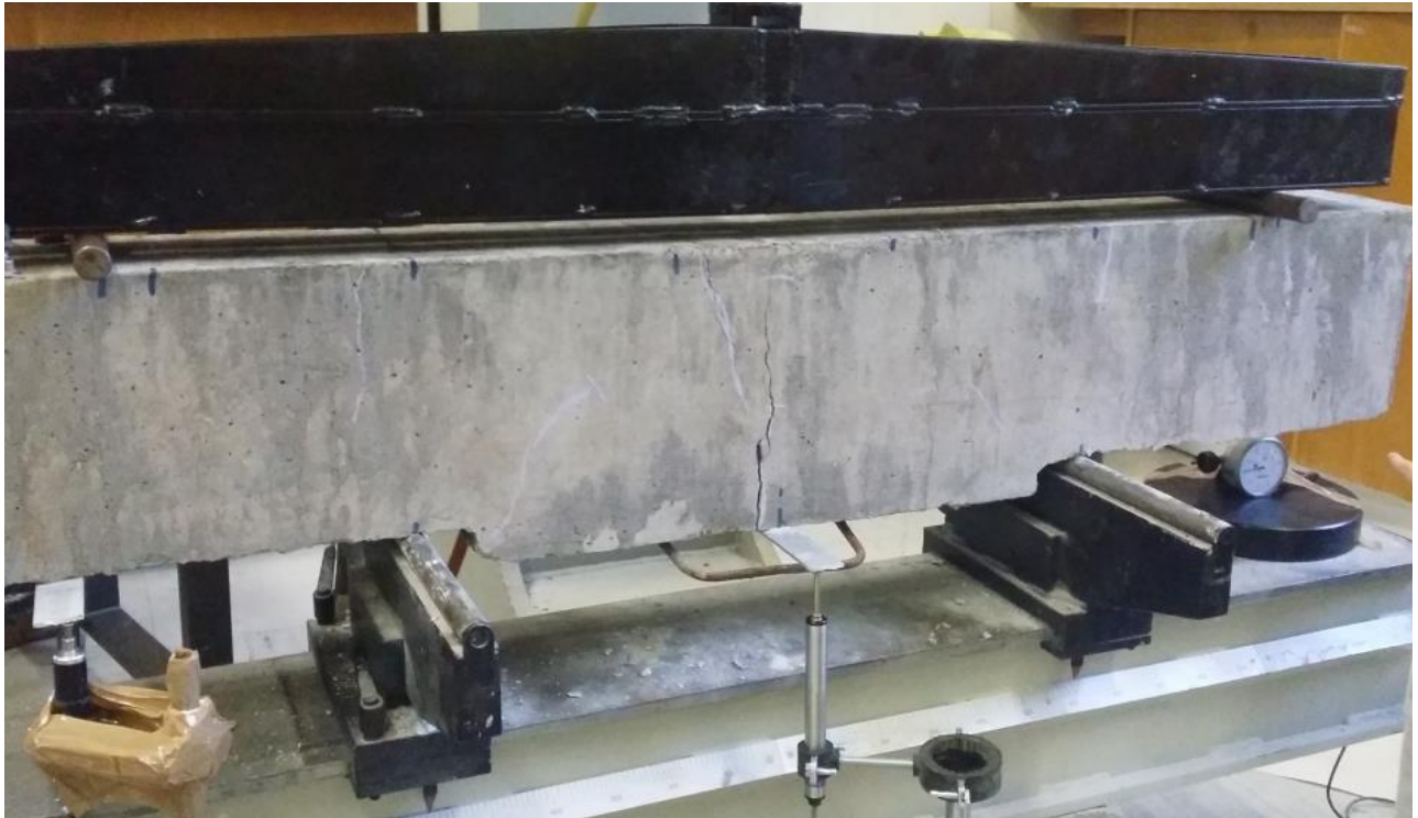
Εικ. 83 Το δοκίμιο με μηχανική αγκύρωση στη μηχανή κάμψης
