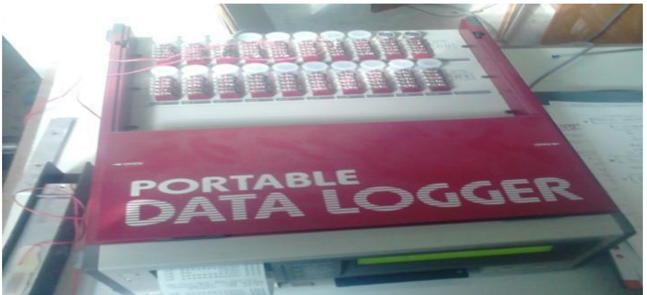
Εικ. 82 Σύστημα καταγραφής μετρήσεων (DATA LOGGER) του ηλεκτρονικού βελόμετρου
