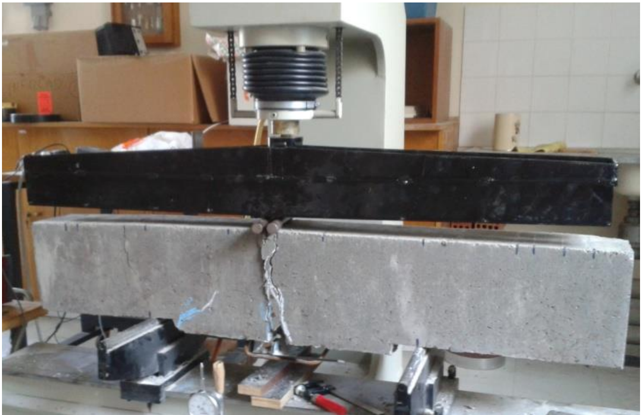
Εικ. 93 Δοκός με ελλiptή αγκύρωση στο τελευταίο κύκλο φόρτισης - αποφόρτισης
