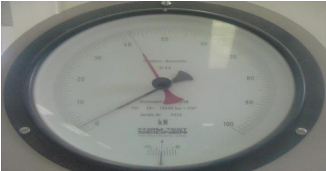
Εικ. 81 Σύστημα καταγραφής φορτίου
