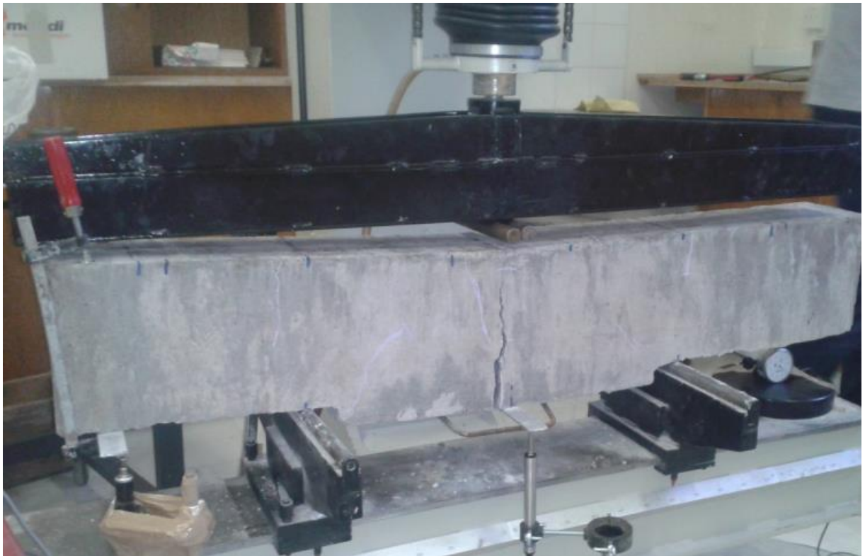
Εικ. 88 Δοκός με μηχανική αγκύρωση (headed bars) σε κατάσταση αστοχίας
