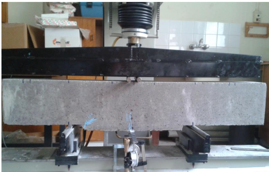
Εικ. 95 Φόρτιση στη μέση της δοκού
