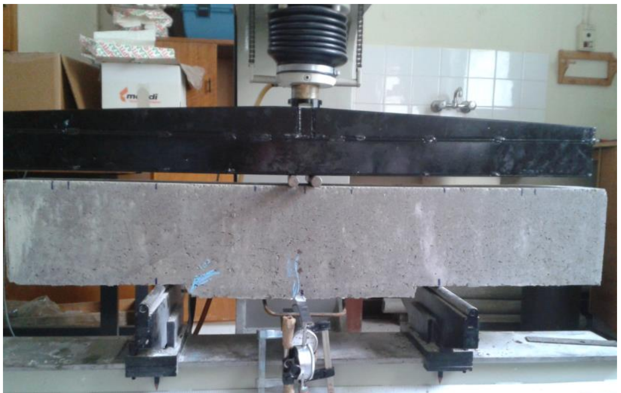
Εικ. 84 Το δοκίμιο με ελλιπή αγκύρωση στη μηχανή κάμψης
