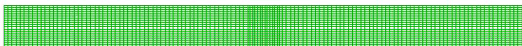
Σχήμα 7.1: Κάνναβος πεπερασμένων διαφορών που χρησιμοποιήθηκε στο λογισμικό FLAC (Itasca Inc. 2005) για την αριθμητική προσομοίωση της σεισμικής απόκρισης επιφανειακού απειρομήκους θεμελίου επί σταθεροποιημένης στρώσης.
