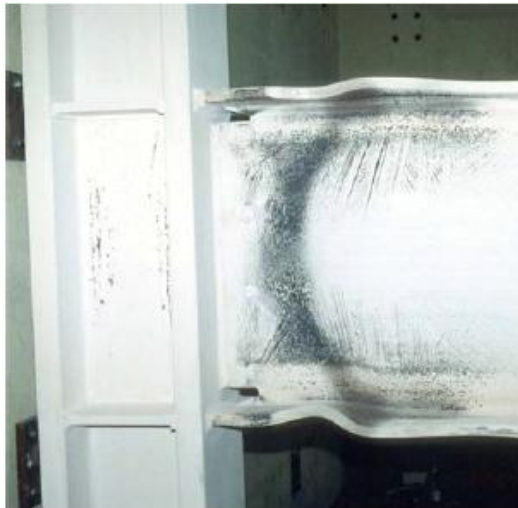
Εικόνα 2.2 : Συμπεριφορά δοκού που ανήκει σε SMRF
