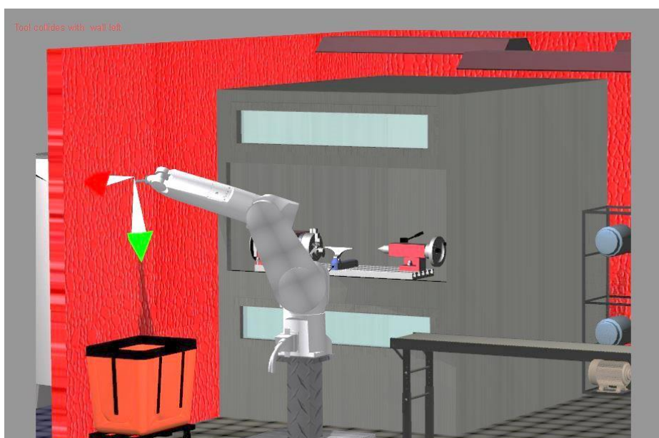
Εικόνα 5.28: Ανίχνευση Σύγκρουσης Εργαλείου με τοίχο
