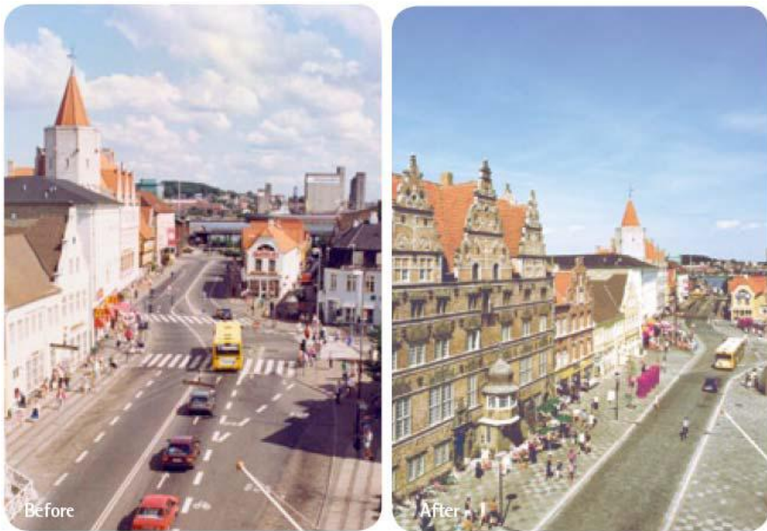
Εικ. 5.24: Διαμόρφωση κεντρικού δρόμου στην περιοχή του Osteragade. Ο οδικός χώρος που χρησιμοποιείται από τη μηχανοκίνητη κυκλοφορία περιορίστηκε στα 6.25 μ και ο υπόλοιπος αποδόθηκε στον πεζό και στον ποδηλάτη.
