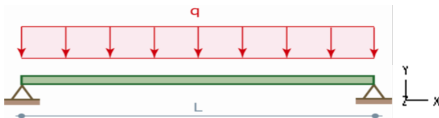
Σχήμα 4-1: Αμφιέρειστη δοκός υπό κατανεμημένη εγκάρσια φόρτιση
