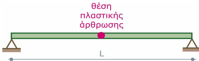
Σχήμα 4-4: Πλαστικός μηχανισμός κατάρρευσης λόγω πλαστικής άρθρωσης στη μεσαία διατομή
