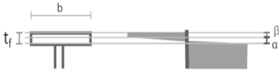
Σχήμα 3-20: Κατανομή τάσεων στο πέλαμα μιας διατομής διπλού ταυ για την περίπτωση (iv) όταν ισχύει (A - 2bt_f) \cdot f_y < N < (A - bt_f) \cdot f_y
