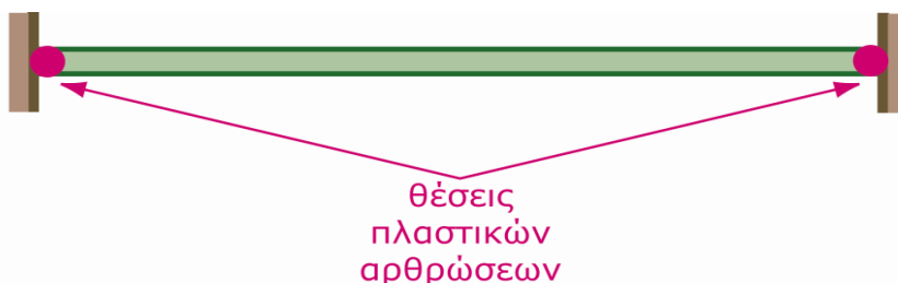
Σχήμα 4-27: Πλαστικές αρθρώσεις στα άκρα της δοκού
