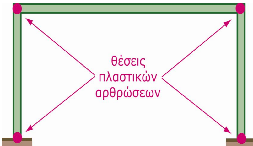
Σχήμα 4-80: Πλαστικός μηχανισμός κατάρρευσης τύπου ορόφου λόγω σχηματισμού τεσσάρων πλαστικών αρθρώσεων
