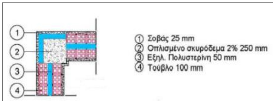
Σχήμα 4.7: Γωνιακό δομικό στοιχείο
