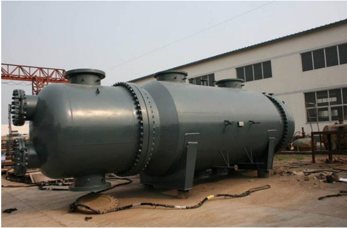
Εικόνα 5.5 Κέλυφος συμπυκνωτή μονάδας ατμοηλεκτρικού σταθμού παραγωγής ηλεκτρικής ενέργειας
