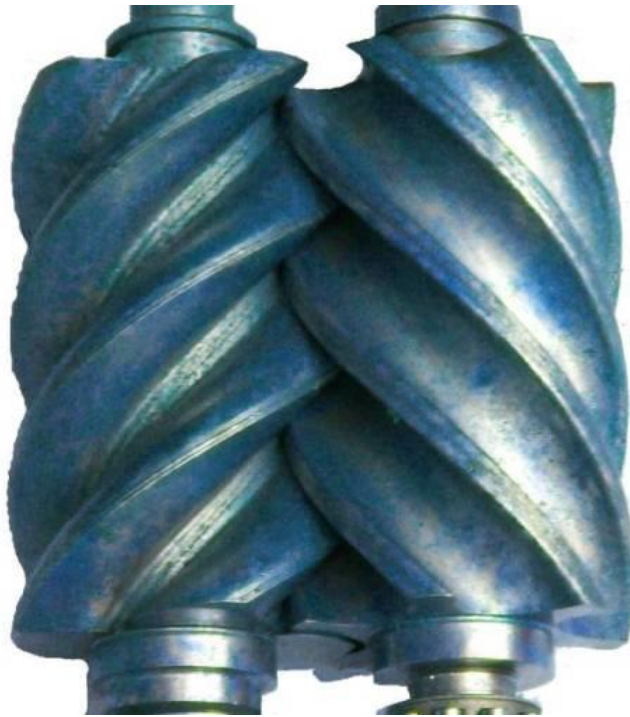
Εικόνα 3.3 Τυπικός συμπιεστής Lysholm.
