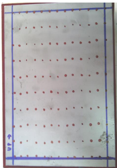
Εικόνα 2-1: Δείγμα μικροκραματωμένου ανθρακούχου χάλυβα, τύπου AISI 4130.
