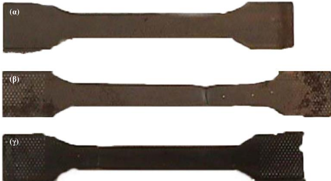
Εικόνα 3-10: Αρχικό δείγμα (α) πριν και (β) μετά τη δοκιμή εφελκυσμού, καθώς και (γ) το δείγμα που είχε υποστεί βαφή στο λάδι.
