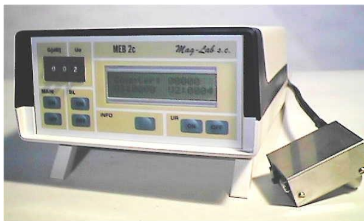
Εικόνα 2-10: Πειραματική διάταξη για τη μέτρηση του μαγνητικού θορύβου Barkhausen.
