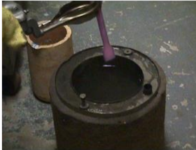
Εικόνα 2-4: Βαφή των δειγμάτων του χάλυβα στο λάδι.
