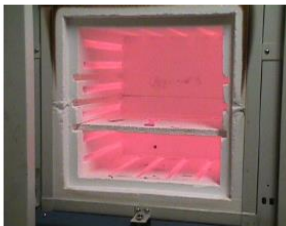
Εικόνα 2-3: Επαγωγικός φούρνος στον οποίο πραγματοποιήθηκε η ισοθερμοκρασιακή ανόπτηση του χάλυβα στους 891 °C για 5 ώρες.
