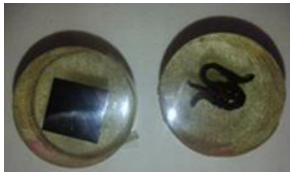
Εικόνα 2-7: Εγκιβωτισμένα δείγματα από την επιφάνεια (αριστερά) και την κάθετη διατομή (δεξιά) του αρχικού δείγματος.
