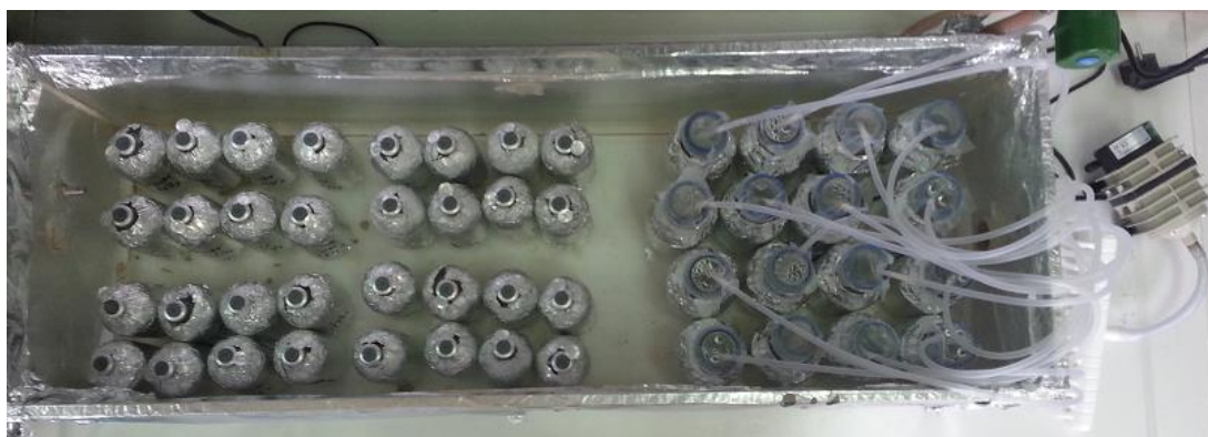
Εικόνα 3.1 Αναερόβιες καλλιέργειες (αριστερά), Ανοξικές καλλιέργειες (κέντρο), Αερόβιες καλλιέργειες (δεξιά)
