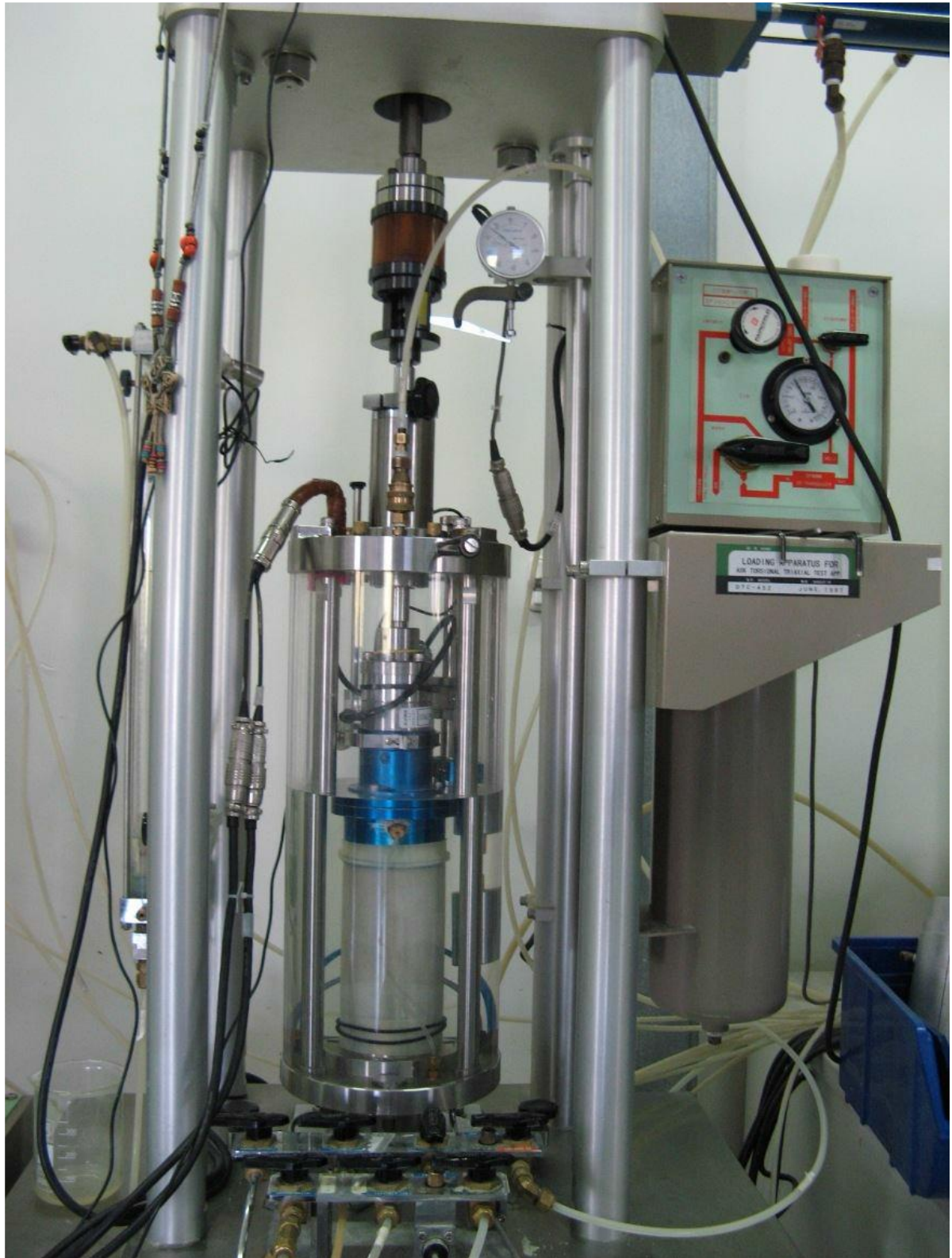
Σχήμα 5.3. Τριαξονική κυψέλη (διακρίνεται στο κέντρο της συσκευής). Δεξιά πάνω βρίσκεται το σύστημα τροφοδότησης για την επιβολή στρεπτικού φορτίου και από κάτω η δεξαμενή εκτόνωσης
