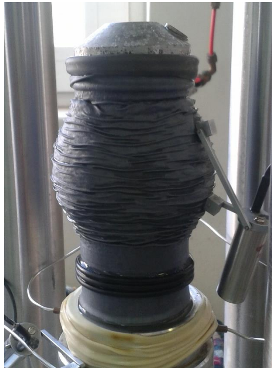
Σχήμα 4.6. Αστοχία δοκιμίου που εκδηλώθηκε με την πλευρική διόγκωση ( bulging )
