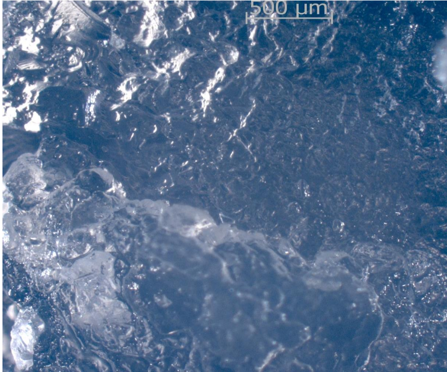
Σχήμα 3.7. Φωτογραφία δείγματος καθαρής κολλοειδούς πυριτίας από ηλεκτρονικό μικροσκόπιο
