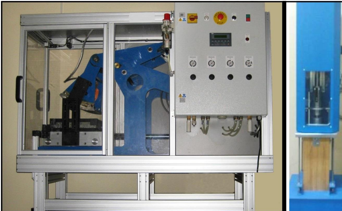
Σχήμα 3.2 Εργαστηριακή συσκευή συμπύκνωσης μεθόδου Roller (αριστερά) και Marshall (δεξιά)
