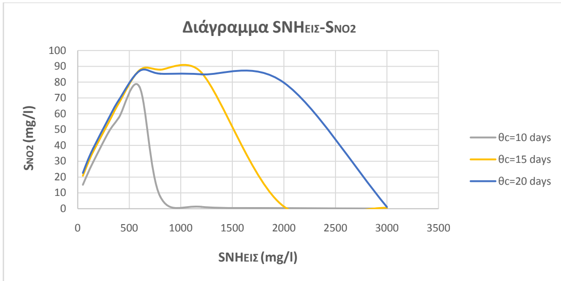
Σχήμα 4.2.39 Νιτρώδες άζωτο S_{NO2} στην εκροή συναρτήσει του S_{NH} εισόδου για διάφορα \theta_c
