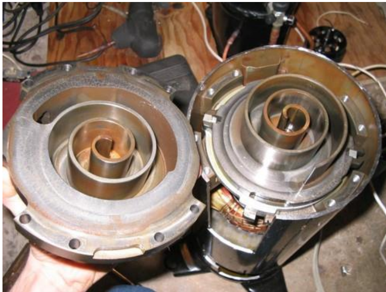
Φωτογραφία 3.3 Αποσυναρμολογημένος ελικοειδής εκτονωτής
