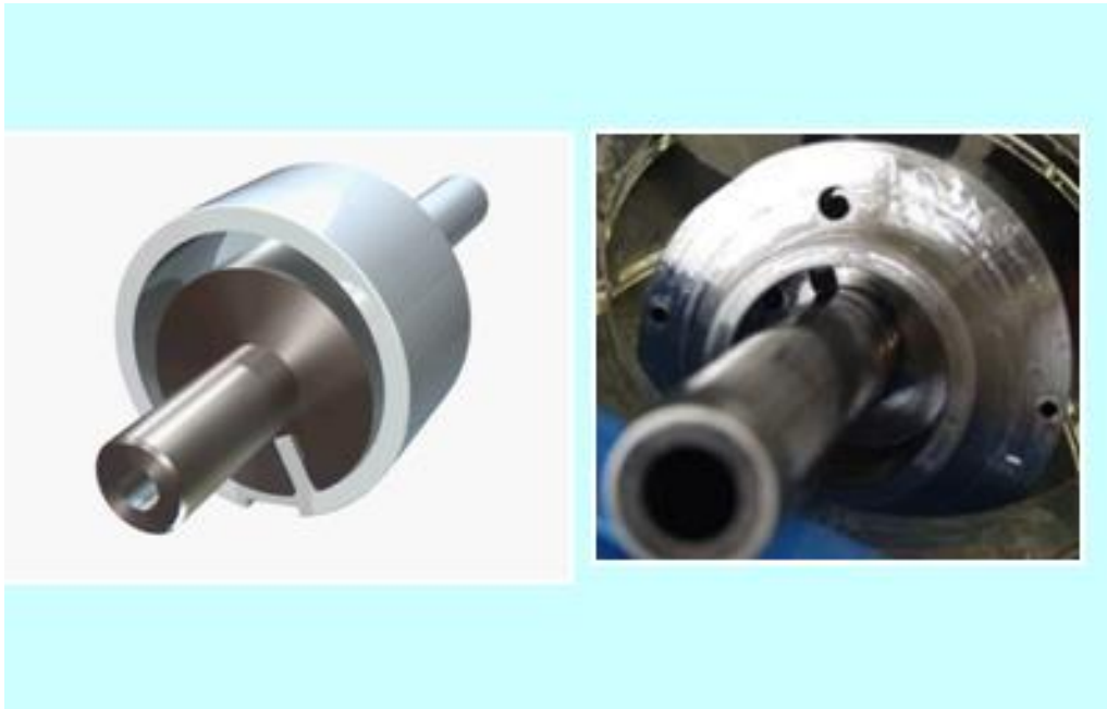
Φωτογραφία 4.2 Περιστροφικός πτερυγιοφόρος συμπιεστής με πτερύγιο πακτωμένο στο σώμα του θαλάμου, το οποίο περιστρέφεται μαζί με τον άξονα (revolving vane compressor).
