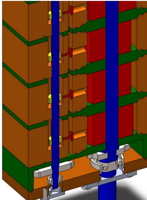
Σχήμα 6.6 Όψη του συναρμολογημένου συνόλου σε τομή, όπου διακρίνεται η αύλακα και οι θυρίδες εισαγωγής.
