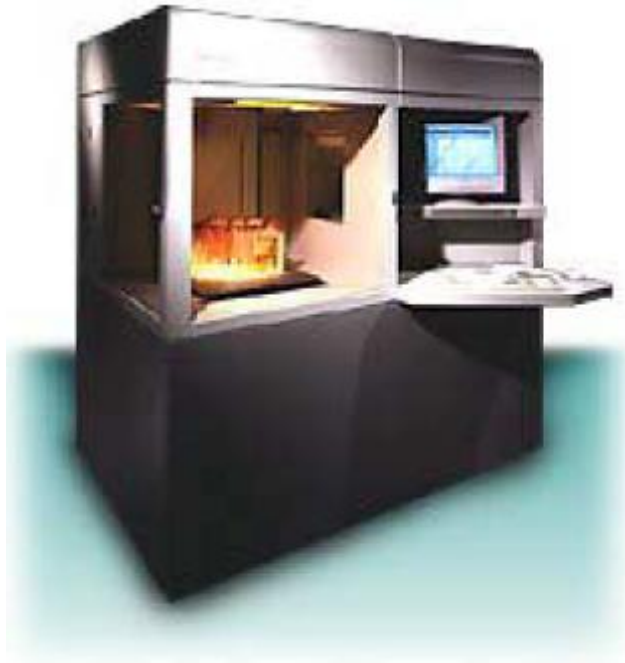
Εικόνα 1.9: Το μηχάνημα στερεολιθογραφίας, μοντέλο SLA5000 της 3D Systems Inc (Kim et al., 2010)
