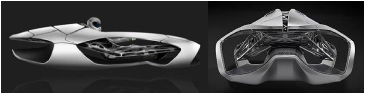
Εικόνα 1.22: Το μοντέλο αυτοκινήτου που δημιουργήθηκε από το πρόγραμμα EDAG Genesis (Frazier, 2014)
