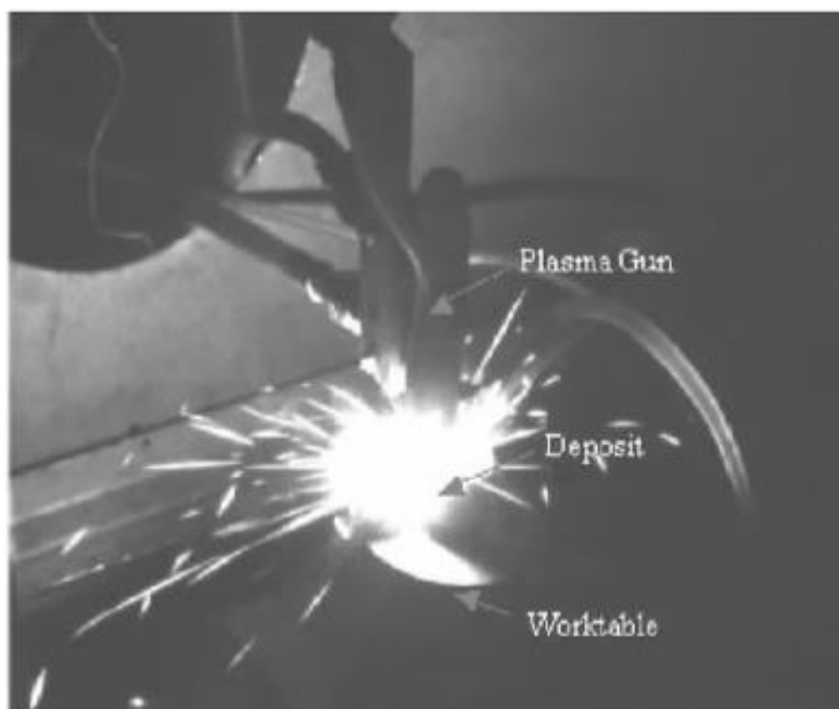
Εικόνα 5.3: Στιγμιότυπο απεικόνισης της κατεργασίας εναπόθεσης με πλάσμα(Zhang et al., 2003)
