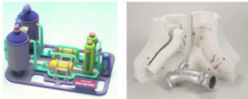
Εικόνα 1.12: Παραγόμενα πρωτότυπα από μηχανήμα τρισδιάστατης εκτύπωσης (3DP) (Wohlert, 2012)
