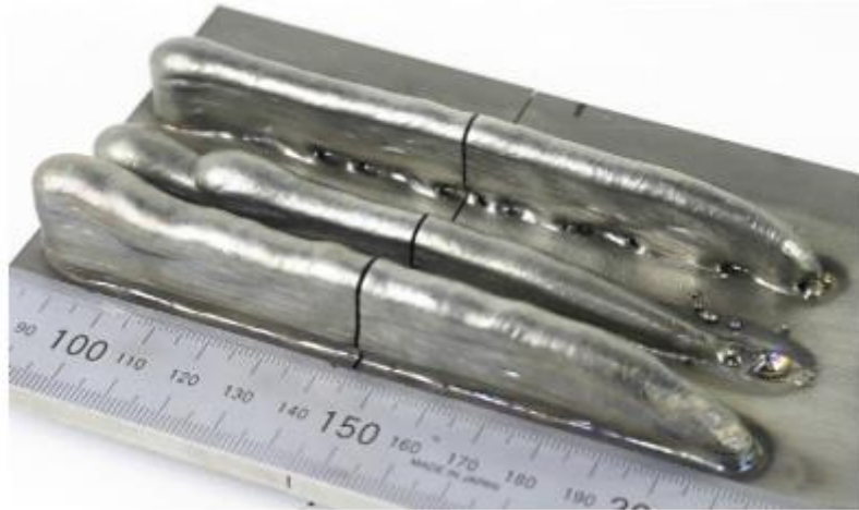
Εικόνα 5.13: Παράδειγμα τοιχώματος Ti6Al4V κατασκευασμένο μέσω PWD (οι κύριες διαστάσεις του χάρακα είναι σε cm) (Martina et al., 2012)
