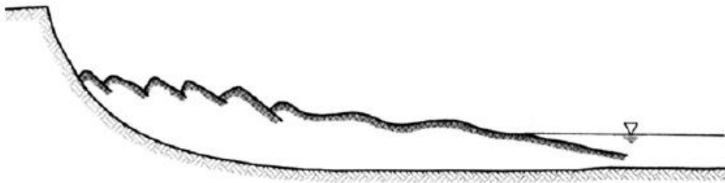
Εικόνα 3.16 Αστοχία όχθης, αποτελούμενη από μη στερεοποιημένη άργιλο και ιλύ. Ταμιευτήρας Sefid-Rud (Tolouie,1993).
