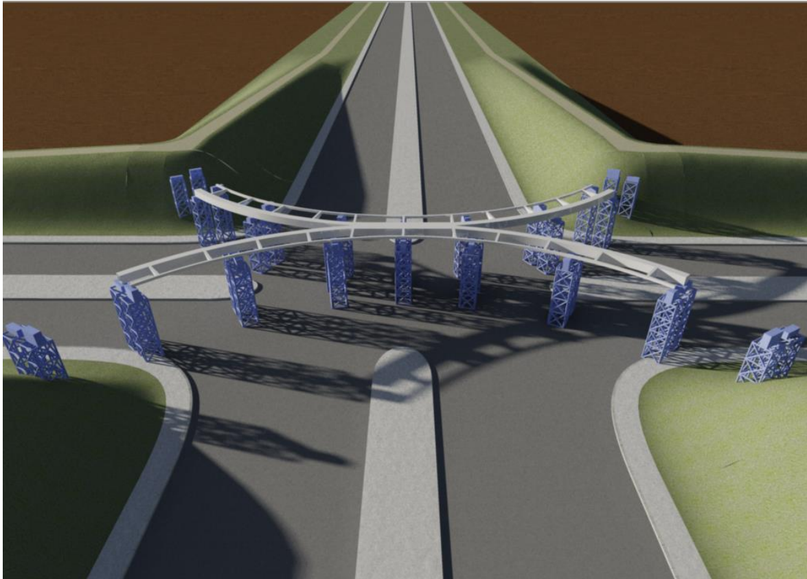
Σχήμα 11.3: Τοποθέτηση και συγκόλληση των προκατασκευασμένων τμημάτων της γέφυρας
