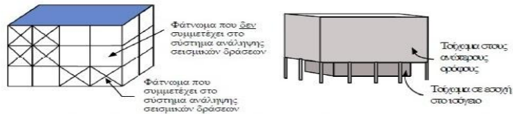
Σχ. 2.7: Παραδείγματα μη κανονικότητας καθ΄ ύψος : Διακοπή φορέα καθ΄ ύψος (αριστερά), εκτός επιπέδου εσοχή (δεξιά).
