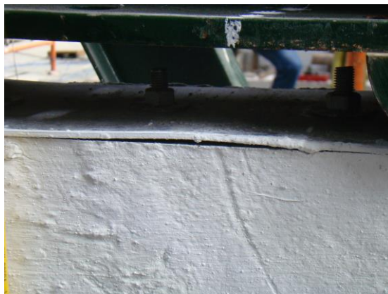
Εικόνα 8.15: Τοπικός λυγισμός θλιβόμενου ελάσματος
