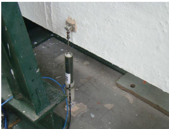
Σχήμα 8.5: Αναπαράσταση φόρτισης τεσσάρων σημείων και διάταξης μετρητών μετατόπισης
