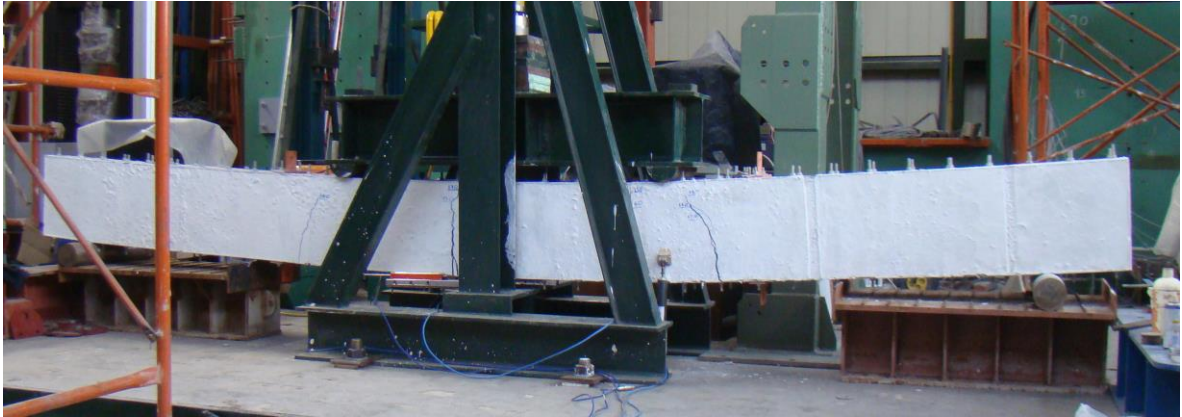
Εικόνα 8.13: Δοκός Α μετά τη πλήρη αποφόρτισή της
