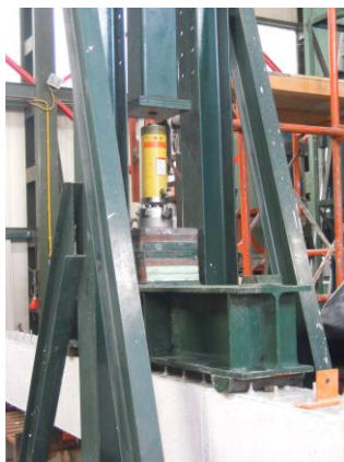
Εικόνα 8.9: Πειραματική διάταξη: α) Υδραυλικός γρύλλος, β) Στήριξη της δοκού με τη χρήση κυλίνδρων
