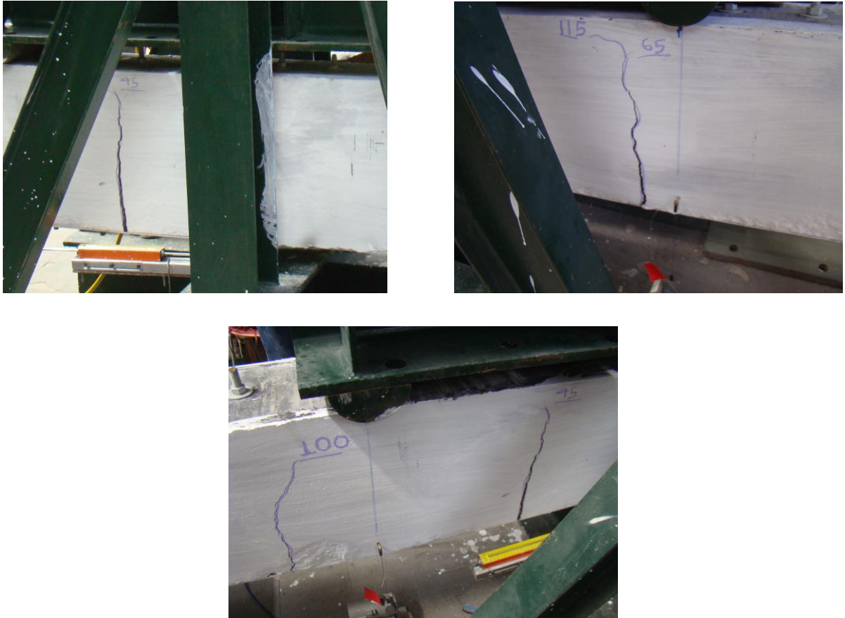
Εικόνα 8.14: Ρωγμές Δοκού Β: α) Στο μέσον της, β) Στο μετρητή μετακίνησης D3, γ) Στο μετρητή μετακίνησης D1
