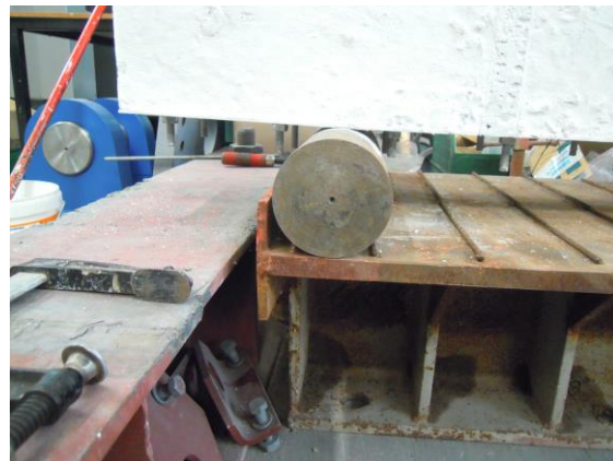
Εικόνα 8.9: Πειραματική διάταξη: α) Υδραυλικός γρύλλος, β) Στήριξη της δοκού με τη χρήση κυλίνδρων
