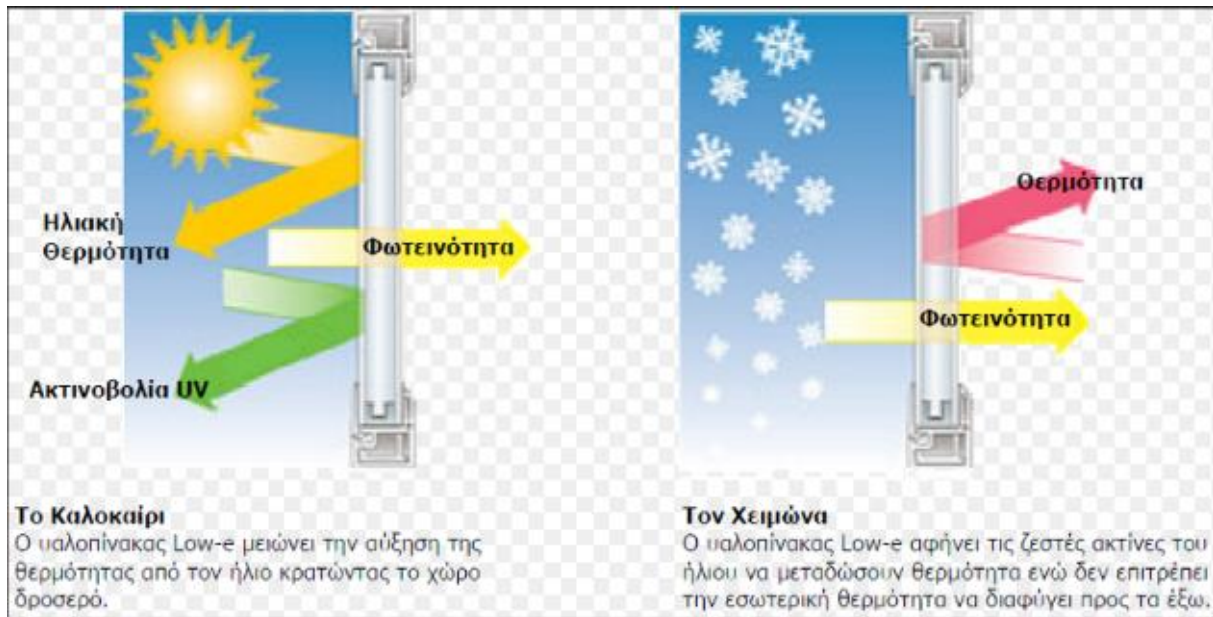
Σχήμα 2.20: Λειτουργία Ενεργειακού Υαλοπίνακα [22]
