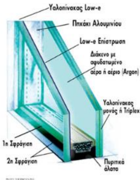
Σχήμα 2.19: Δομή Ενεργειακού Υαλοπίνακα [22]
