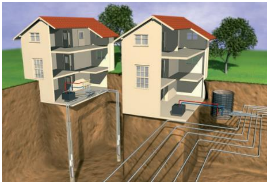
Σχήμα 2.16: Εκμετάλλευση Γεωθερμικής Ενέργειας [19]
