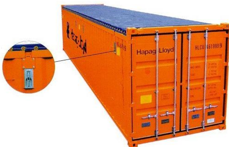
Εικόνα Α- 3: Εμπορευματοκιβώτιο ανοιχτής οροφής. Πηγή: [11]
