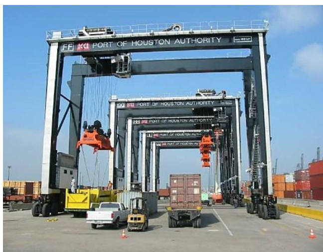
Εικόνα 1. 13: Γερανογέφυρες επί ελαστικών τροχών. Πηγή: [7]
