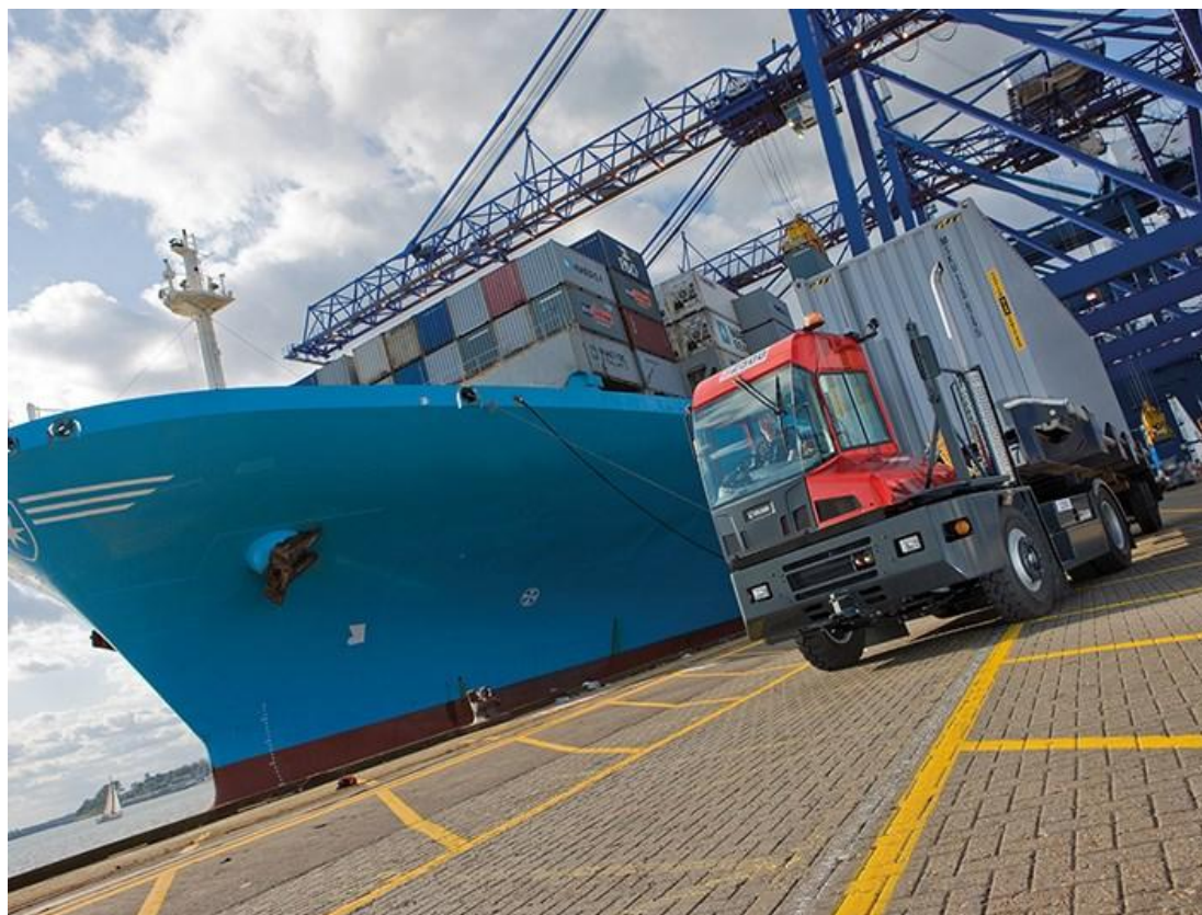
Εικόνα 1. 5: Ελκυστήρες με συρόμενες βάσεις. Πηγή: [6]
