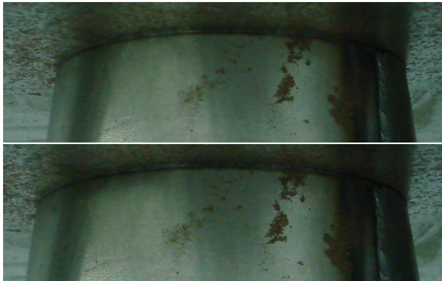
Εικόνα 8.15. Σχηματισμός δαχτυλιδιού στο κυκλικό άκρο του δοκιμίου 100b. Αποτελεί μεγέθυνση μέρος της εικόνας 8.8 στα σημεία 4 (πάνω) και 5 (κάτω).
