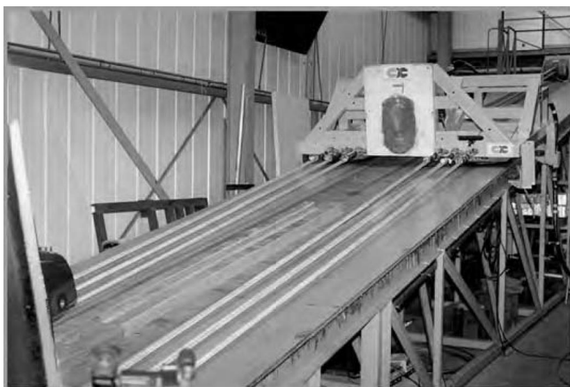
Εικόνα 5.3. Μηχανή δοκιμών Sled, που βρίσκεται στο κέντρο δοκιμών συγκρούσεων του Cranfield [1].
