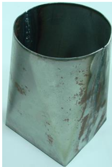
Εικόνα 6.1. Λεπτότοιχο δοκίμιο υβριδικής γεωμετρίας κατασκευασμένο από μαλακό χάλυβα.
