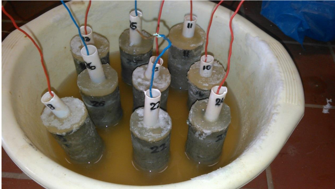
Σχήμα 34: Διάλυμα NaCl στο δοχείο με τα δοκίμια των ομάδων 2 και 4 (επικάλυψη με αναστολέα διάβρωσης στην επιφάνεια του τσιμεντοκονιάματος) έξι μήνες μετά από την έναρξη του πειράματος
