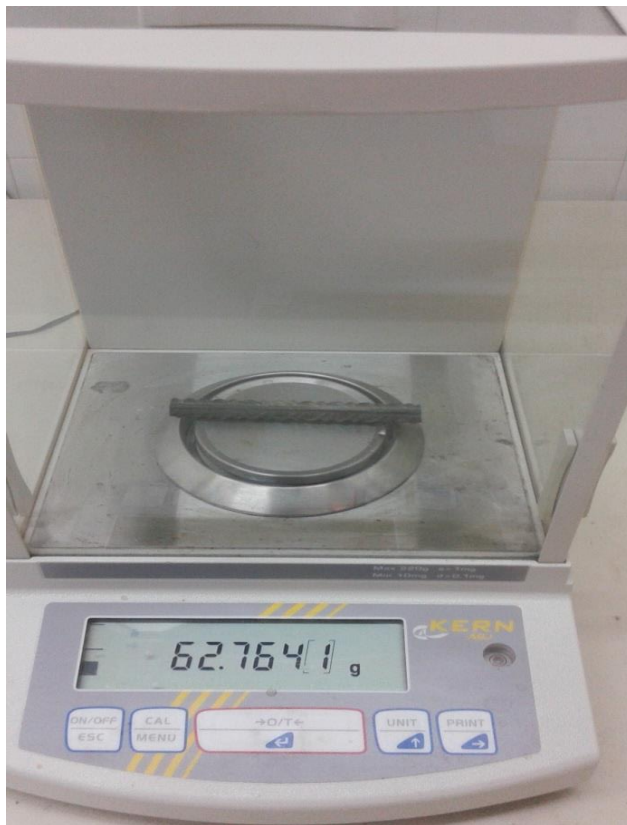
Σχήμα 7: Διαδικασία ζύγισης οπλισμών χάλυβα σε ζυγό ισορροπίας
