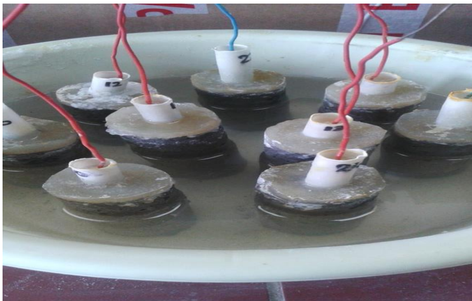
Σχήμα 36: Διάλυμα NaCl στο δοχείο με τα δοκίμια των ομάδων 2 και 4 (επικάλυψη με αναστολέα διάβρωσης στην επιφάνεια του τσιμεντοκονιάματος) τρεις μήνες μετά από την ανανέωση του διαλύματος
