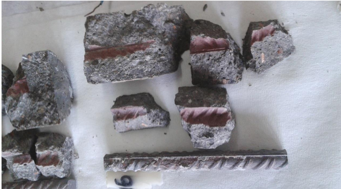
Σχήμα 40: Κόκκινο αποτύπωμα επάνω στο τσιμεντοκονίαμα από τον αναστολέα διάβρωσης επάνω στον οπλισμό στο δοκίμιο 16 της ομάδας 3
