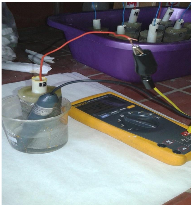
Σχήμα 8: Μέτρηση δυναμικού διάβρωσης του οπλισμού με ηλεκτρονικό πολύμετρο
