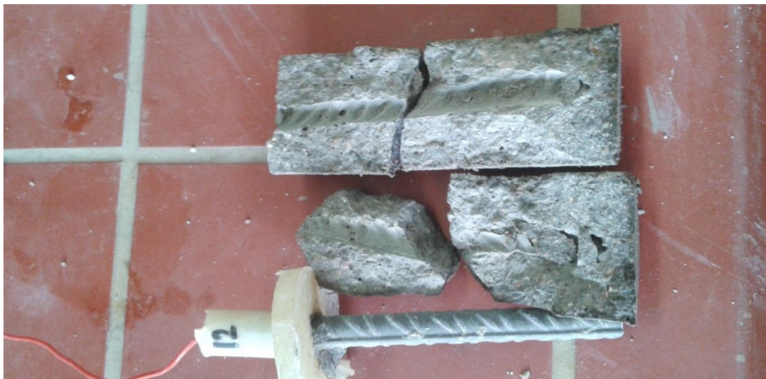
Σχήμα 41: Απουσία κόκκινου αποτυπώματος επάνω στο τσιμεντοκονίαμα λόγω της μη εφαρμογής αναστολέα διάβρωσης στον οπλισμό του δοκίμιου 12 της ομάδας 2
