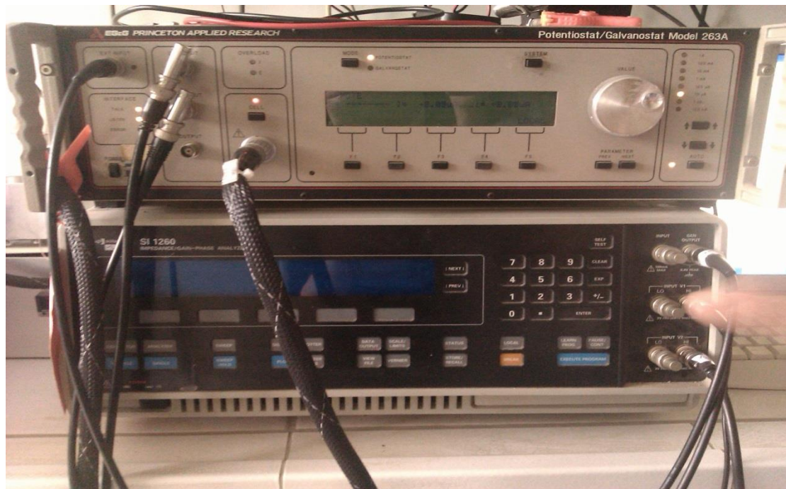
Σχήμα 18: Ποτενσιοστάτης / γαλβανοστάτης της EG&G Princeton Applied Research Model 263A
