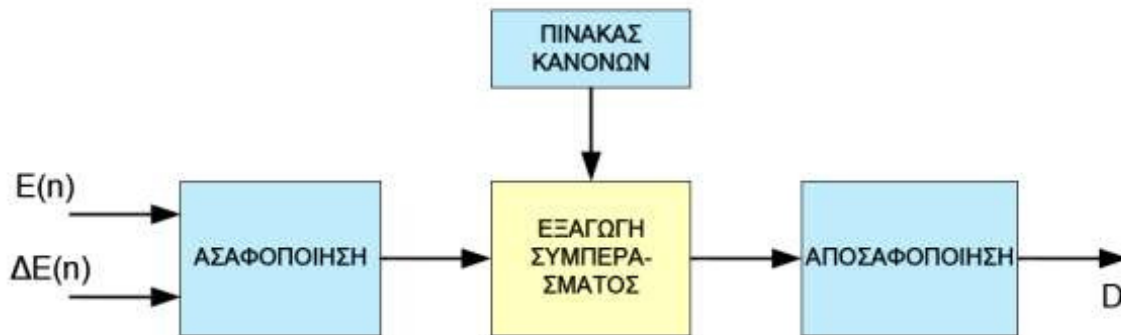
Σχήμα 2.6 - Γενική δομή ελεγκτή Ασαφούς Λογικής για την εύρεση του ΣΜΙ [41]
